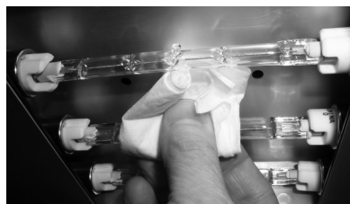
Figura 14. Substituição da Lâmpada
