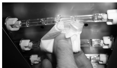
Figure 14. Remplacement des lampes
