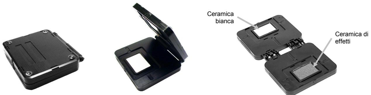
Posizionare l'apertura di misurazione (1) dello strumento sopra la ceramica bianca (2) sul riferimento di calibrazione. Assicurarsi che i tre sensori di pressione intorno all'apertura di misurazione si allineano con gli incavi (3) nel riferimento di calibrazione, e che la riga bianca (4) si allinea con i punti di riferimento.
