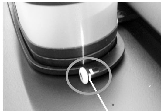
Alinhamento frontal incorreto
