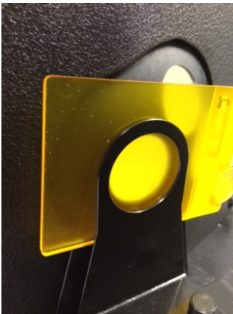
Porte-échantillon de transmission avec un échantillon placé côté sphère (mesure totale) pour les mesures de 25 mm, 17 mm, 10 mm et 6 mm
