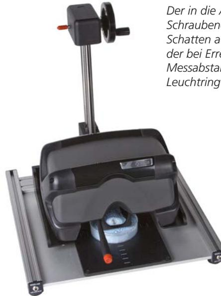
*Der in die Aussparung eingeführte Schraubendreher wirft einen Schatten auf die Probenoberfläche, der bei Erreichen des korrekten Messabstands den projizierten Leuchtring des VS450 exakt halbiert.*
