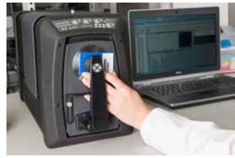
Ein Spektralfotometer misst die Spektraldaten, d. h. die Menge an Lichtenergie, die von einem Objekt in mehreren Intervallen entlang des sichtbaren Spektrums reflektiert wird. Die Spektraldaten werden in Form einer Spektralkurve dargestellt.
