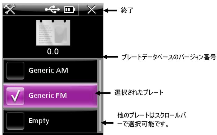
3. 操作リングで使用したいプレートをハイライト表示します。操作リングの上下を押して他のプレートを画面に表示します。
