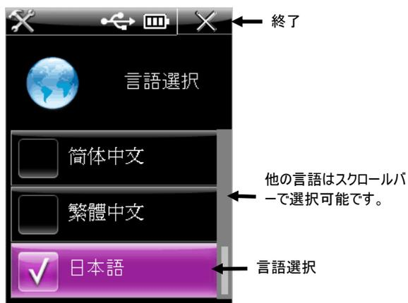
3. 操作リングで使用したい言語をハイライト表示します。操作リングの上下を押して他の言語を画面に表示します。
