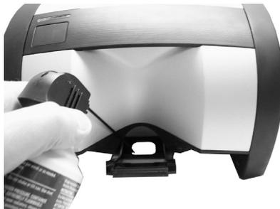
3. Positionnez la plaque coulissante de l'instrument en position de mesure.
