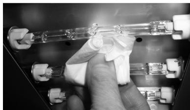
Figura 14. Substituição da Lâmpada
