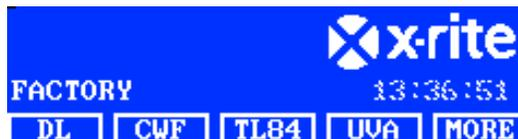
**NOTA:** ao desligar a SpectraLight QC, espere pelo menos 5 segundos antes de ligá-la novamente. Esse tempo permite que o equipamento e o programa interno (firmware) se desativem corretamente. Caso tente ligar a unidade antes de que decorram pelo menos 5 segundos depois de desligá-la, pode ser que nada aconteça. Neste caso, desligue a unidade, espere 5 segundos no mínimo e, em seguida, ligue-a usando o interruptor liga/desliga.
