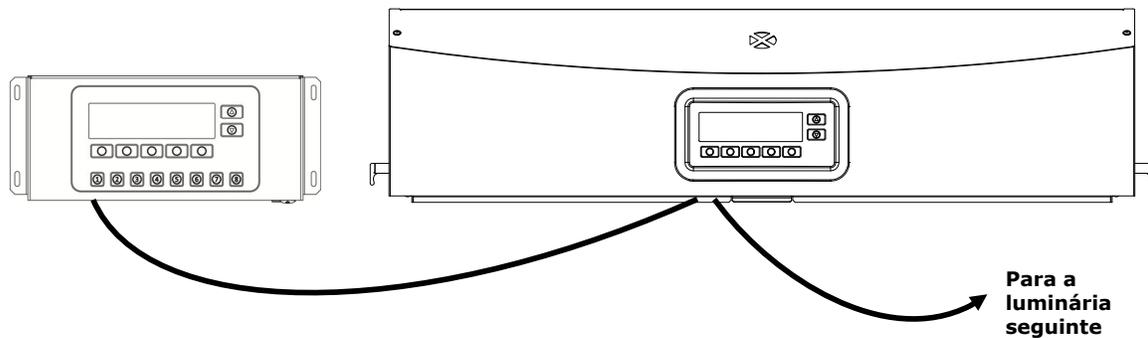
4. Prossiga conectando os cabos de encadeamento às luminárias restantes (entrada pela porta esquerda e saída pela porta direita).
