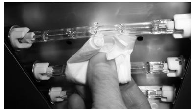
Figura 14. Sostituzione delle lampade
