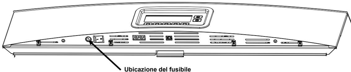
3. Rimuovere il portafusibile ed eliminare il fusibile bruciato.
