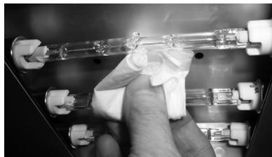
Figure 14. Remplacement des lampes
