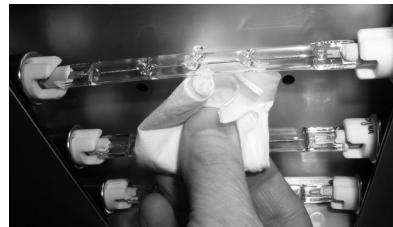
Figura 14. Sustitución de las lámparas
