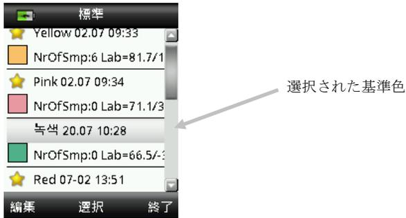
2. 操作（編集）ボタンの左を押し、[基準色の編集] スクリーンに進みます。
