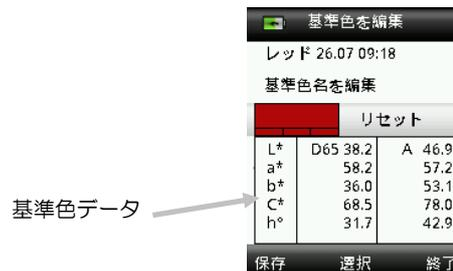
8. 基準色名を入力するには、操作ボタンを上下に押して [基準色名を編集] を選択し、Enter（編集）ボタンを押します。
