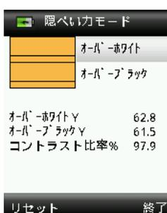
5. 別の隠ぺいカ測定を行う場合は、操作ボタンの左側を押して結果を消去（リセット）し、測定作業を再度実行してください。
