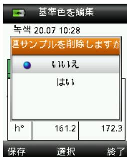
5. 操作ボタンを上下に押して [はい] を選択し、Enterボタンを押して変更を保存します。
