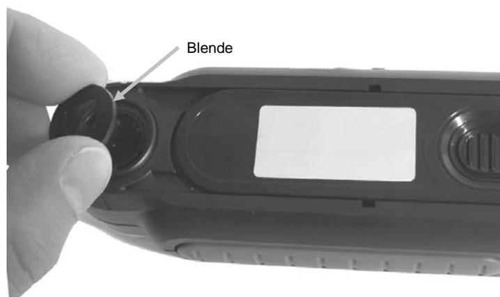
3. Blasen Sie kurze Stöße von sauberer, trockener Druckluft in die Messöffnung. Dies sollte eventuell Verunreinigung aus der Optik entfernen.
