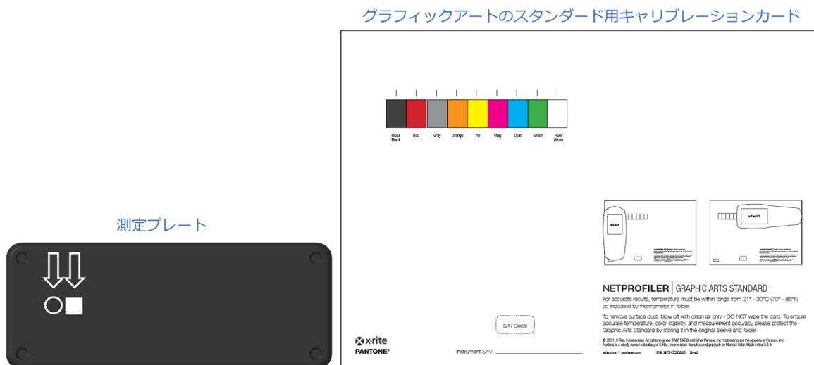
測定プレートには、繰り返し精度の検証とプロフィール作成に使用するホワイト測定スポットおよびブラック測定スポットが付いています。キャリブレーションカードには 9 つのカラーパッチがあります。中央の 7 色カラーパッチはプロファイル作成に使用します。2 つの非プロファイル作成用測定パッチは偏光フィルターが正しく動作しているかどうか、また、UV LED が UV/可視バランスを実現するにあたり適切なレベルであるかどうかを検証します。
