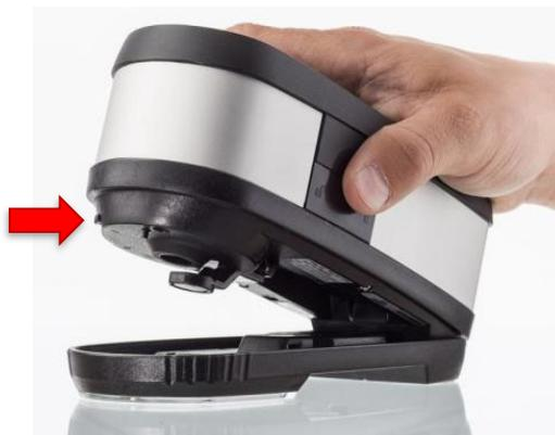
NetProfiler génère des profils pour chacun de ces modes. Au cours de la procédure de caractérisation, vous êtes régulièrement invité à basculer entre les deux configurations de mesure.
