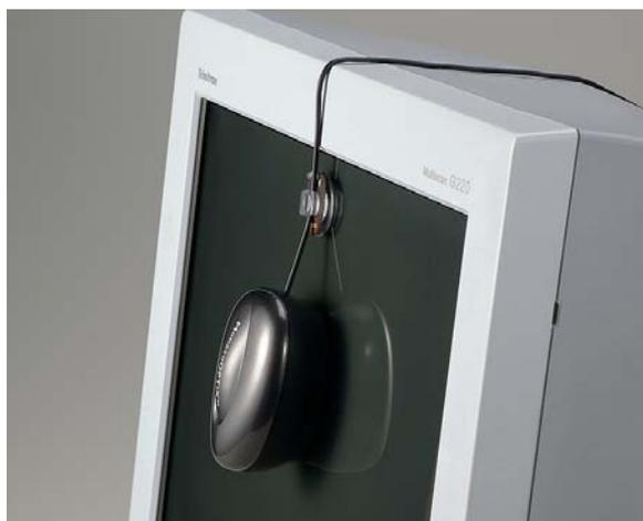
CRT モニタの場合、付属の吸盤を利用し表面に吸着させて固定します。適度にセンサーとの距離を調整し、隙間が出来ないように注意します。
