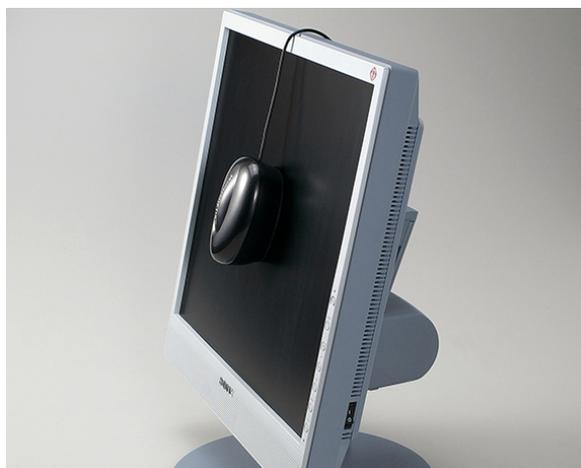
LCD モニタの場合、表面に強く圧力をかけることは禁物です。写真のようにモニタの裏側にくる部分に付属のバランスウェイトをつけ、上部からつり下げます。モニタの角度は、自然にセンサーが添う程度にします。
