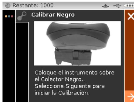
El instrumento realiza 4 a 8 mediciones dependiendo del modelo. Después de finalizar las mediciones de calibración del negro, quite el instrumento del colector negro, instale la tapa del orificio y vuelva a colocar el colector en la ubicación de almacenamiento.
