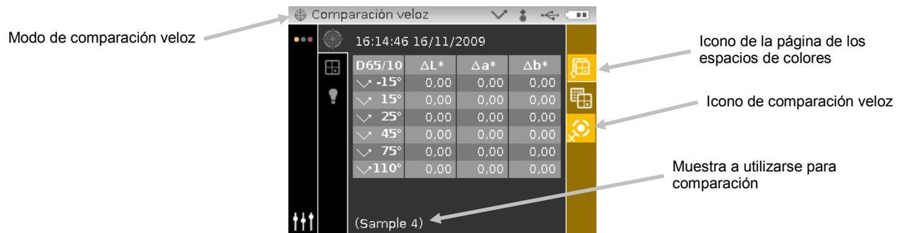
4. Posicione el instrumento sobre la muestra para comparar y realizar la medición.
