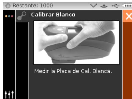
El instrumento realiza 1 a 2 mediciones dependiendo del modelo. Después de finalizar la o las mediciones de calibración del blanco, pulse el botón **Seleccionar** para volver a la pantalla principal.
