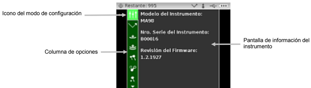
3. Utilice los botones de navegación **Arriba** o **Abajo** en la pantalla de Configuración para resaltar el icono de configuración deseado en la columna Opciones.
