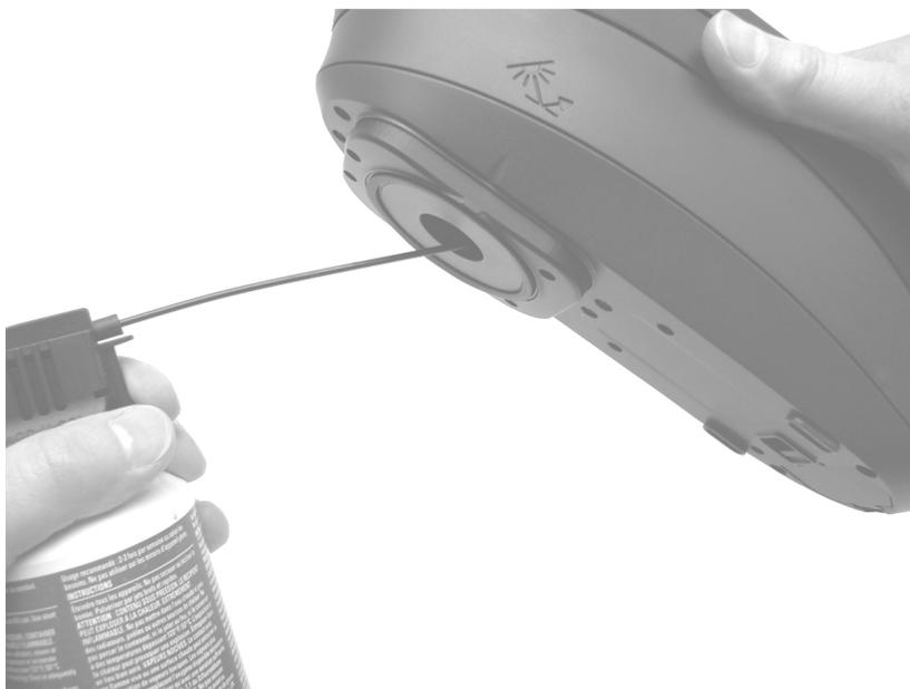
**IMPORTANTE:** Si se utiliza aire para la limpieza, no gire o incline la lata durante el uso. Esto puede causar daños al ensamblaje de la óptica.
