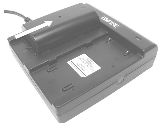
5. Después de finalizar la carga, deslice la batería en la dirección opuesta del LED hasta que se detenga y levántela hacia arriba para retirarla.
