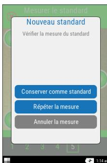
11. Quand vous appuyez sur Conserver comme standard, l'instrument passe en mode de visée. Positionnez l'instrument sur la zone de l'échantillon à mesurer en suivant les instructions de la procédure Positionnement de l'instrument.
