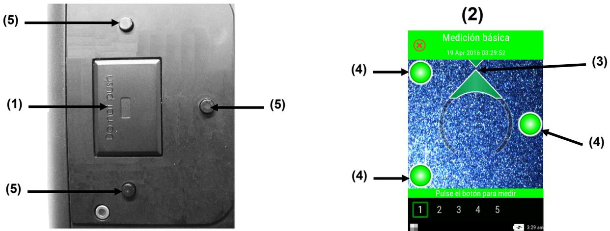
3. Agite suavemente el instrumento hasta que los tres indicadores de posicionamiento (4) en la pantalla se vuelven verdes. Esto indica que todos los tres sensores de presión (5) se han activado y ahora se puede hacer una medición.
