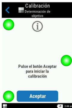
**NOTA:** Si aparece un mensaje de error después de la calibración con la cerámica blanca, intente medirla de nuevo. Si todavía tiene problemas, limpie la referencia de calibración del blanco como se explica en los Apéndices.
