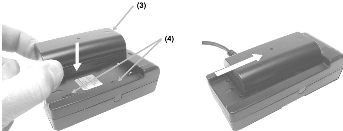
5. Después de finalizar la carga, deslice la batería en la dirección opuesta del LED hasta que se detenga y levántela hacia arriba para retirarla.
