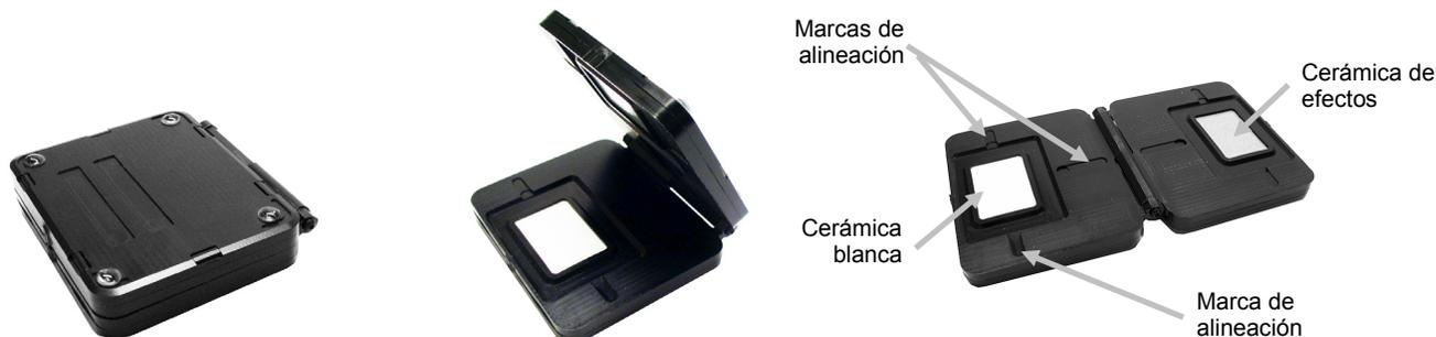
Acueste la referencia de calibración de modo plano. Coloque el instrumento sobre la referencia de calibración, sobre la cerámica blanca, de modo que los tres sensores de presión alrededor del puerto de medición se alineen con las marcas en la referencia de calibración, y que los trazos blancos se alineen. Esto asegura que el instrumento esté colocado correctamente sobre la cerámica blanca o bien sobre la cerámica de efectos.
