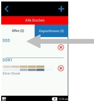
4. Die Checkpoints für die Messung des gewählten Jobs werden angezeigt. In diesem Beispiel müssen Motorhaube und Stoßfänger gemessen werden. Tippen Sie in der Checkpointliste auf **Motorhaube**, um das Gerät in den Zielmodus zu setzen.
