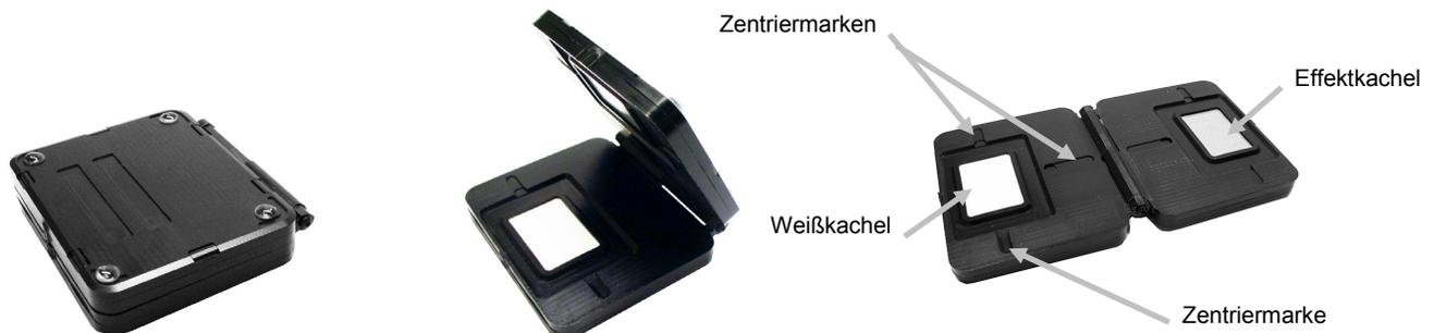
Legen Sie die Kalibrierreferenz auf eine flache Oberfläche. Platzieren Sie das Gerät auf der Kalibrierreferenz über der weißen Kachel, bis die 3 Drucksensoren mit den Schlitten und der weißen Linie auf dem Standard ausgerichtet sind. Das Gerät ist dann richtig platziert.
