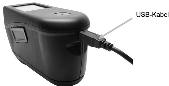
Wenn das Gerät angeschlossen wird, dann schaltet sich das Display ein und es erscheint ein Blitzsymbol. Das Gerät schaltet sich nicht ein, wenn es mit der USB-Schnittstelle am Computer verbunden wird. Es geht dann in den Standby-Modus. Dies wird durch eine blau blinkende LED angezeigt.
