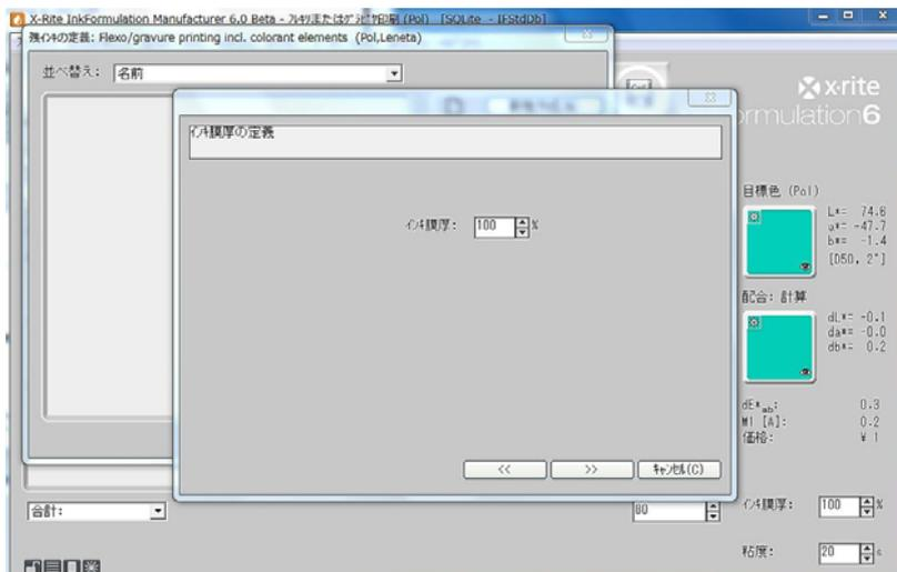
注記：実際の使用においては支持体を測定します。これは使用する支持体が基礎データの支持体と異なるためです。InkFormulation では、支持体色が正しく補正されるよう正確な支持体情報を取得することが極めて重要です。
