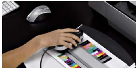
Si el software indica que el instrumento no está calibrado, pulse el botón **Calibrar** para calibrar el i1. Asegúrese de que el instrumento i1Pro esté posicionado correctamente sobre la cerámica blanca de calibración. La calibración puede tardar alrededor de un minuto.
