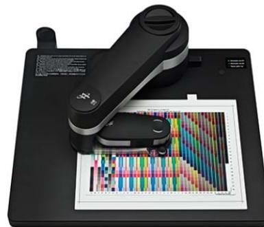
Haga clic en el botón Configurar en la página de medición para abrir la página de configuración del instrumento iO. Haga clic en el botón Calibrar para calibrar el dispositivo y, a continuación, alinee el objetivo con las coordenadas 1, 2 y 3 del gráfico de prueba. Haga clic en el botón Medir para empezar la medición.
