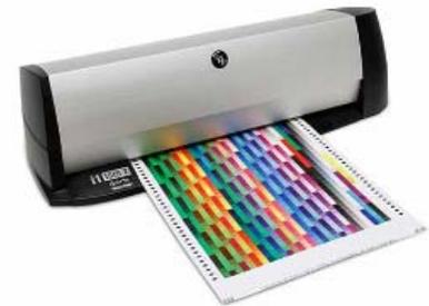
Wählen Sie die gewünschte Messbedingung. Bei Verwendung eines i1iSis können Sie zwischen M0 (entspricht Messungen mit UV) und M2 (entspricht UV-Cut) wählen. Bei Verwendung eines i1iSis 2 können die Optionen M0, M1 und M2 gewählt werden. Weitere Informationen hierzu finden Sie im Handbuch unter 'Kurze Einführung: Messbedingungen ISO 13655 M0, M1, M2' im Abschnitt 'Einführung in die Benutzung von i1 Process Control'.
