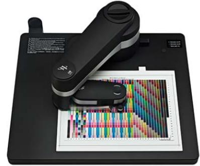
Klicken Sie auf der Messseite auf Setup, um die Setup-Seite für das iO zu öffnen. Klicken Sie auf Kalibrieren, um das Gerät zu kalibrieren. Richten Sie das Testchart mit den Koordinaten 1, 2 und 3 auf dem Messtisch aus. Klicken Sie auf Messen, um die Messung zu starten.
