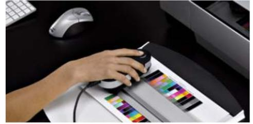
Falls die Software anzeigt, dass eine Kalibrierung erforderlich ist, klicken Sie auf **Kalibrieren**, um das i1 zu kalibrieren. Achten Sie darauf, dass das i1Pro korrekt auf der weißen Kachel platziert wurde. Die Kalibrierung dauert ca. eine Minute.
