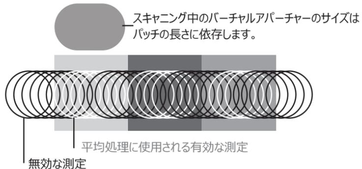
i1Pro 3 装置は、スキャン測定において 1 秒間に 400 回の測定を行います。装置の自動パッチ検出機能は、パッチの有効な測定値とパッチ間の無効な測定値を判別します。パッチの有効な測定値は平均化され、装置は平均測定結果をソフトウェアに出力します。この技術により、i1Pro 3 装置のバーチャルアパーチャーはパッチの長さに対して適応することが可能です。最良の測定結果を得るには、テストチャートのパッチ長をプリンタの解像度に基づいて選択してください。パッチ幅を拡大すると、より正確な結果が出力される時もあります。
