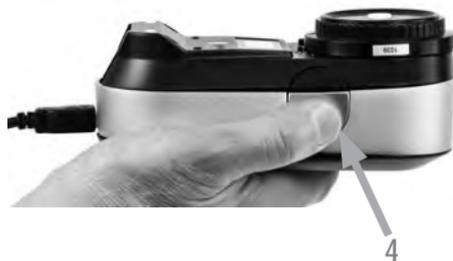
Avant d'initier une mesure, fixez la tête de mesure de l'éclairage ambiant sur l'ouverture de limitation de faisceau de l'i1Pro 3. Si vous possédez plusieurs instruments, assurez-vous que le numéro de série figurant sur la tête de mesure de l'éclairage ambiant correspond au numéro de série de votre i1Pro 3. Vous pouvez également utiliser la tête de mesure de l'éclairage ambiant conjointement avec le support pour trépied.
