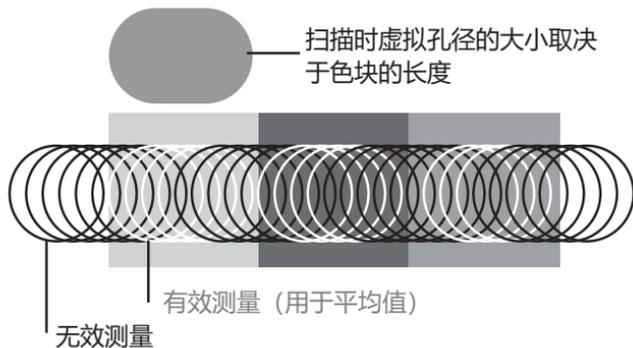
在扫描测量中，i1Pro 3 设备每秒执行 400 次测量。设备的自动色块检测功能会辨认一块色块上的可用测量值和在两块色块之间不可用的测量值。将平均计算一块色块上的有效测量值，然后设备将该平均值发送到软件。凭借这项技术，i1Pro 3 设备的虚拟孔径得以适应色块的长度。为了得到最佳测量结果，测试图表上的色块长度应根据打印机的分辨率做出选择。某些情况下，增加色块宽度会产生更准确的结果。
