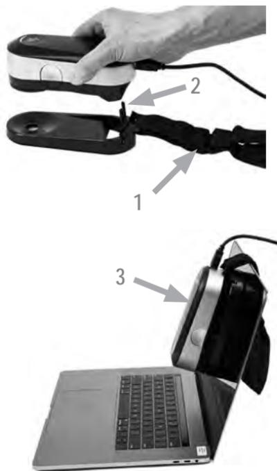
Para preparar el dispositivo i1Pro 3 para una medición de pantalla, es necesario montarlo en el soporte para pantalla. Asegúrese de que el dispositivo esté calibrado y que el indicador de estado esté pulsando en color blanco antes de montar el dispositivo.
