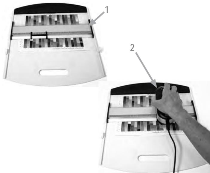
スキャン測定を行うには、i1Pro 3 装置をルーラーに取り付ける必要があります。装置を取り付ける前に、キャリブレーションが完了しており、ステータス・インジケータの照明が白で点滅していることを確認してください。
