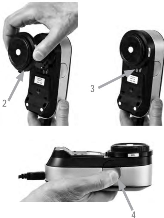
測定を開始する前に、環境光の測定ヘッドを i1Pro 3 装置の測定アパーチャーに装着してください。複数の装置を保有する場合は、環境光源測定ヘッドのシリアル番号が i1Pro 3 装置のシリアル番号と一致することを確認してください。環境光測定ヘッドは三脚ホルダーと共に使用することもできます。
