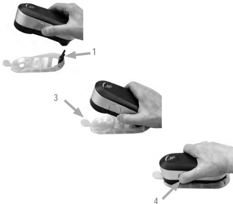
Vor der Einzelmessung müssen Sie das i1Pro 3 auf der Positionsblende befestigen. Bitte achten Sie darauf, dass das Gerät kalibriert ist, und dass die Statusanzeige vor der Montage des Geräts weiß pulsiert. Weitere Informationen zur Einzelmessung finden Sie im Handbuch Ihrer Software.
