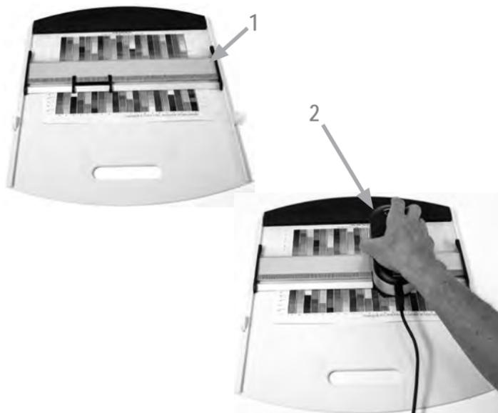
Para preparar el dispositivo i1Pro para una medición por digitalización, es necesario montarlo en la regla. Asegúrese de que el dispositivo esté calibrado y que el indicador de estado esté pulsando en color blanco antes de montarlo.
