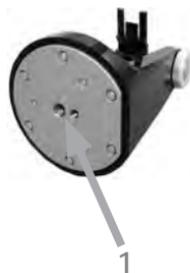
Pour préparer votre i1Pro 3 en vue de prendre des mesures de projecteur, vous pouvez soit utiliser l'instrument sur le support pour trépied, soit monter le support pour trépied sur un trépied avec l'une des deux vis standard fournies par vos soins (1). Montez ensuite l'i1Pro 3 sur le support pour trépied. Assurez-vous que votre instrument est étalonné et que l'indicateur d'état émet une lumière blanche clignotante avant de le monter.
