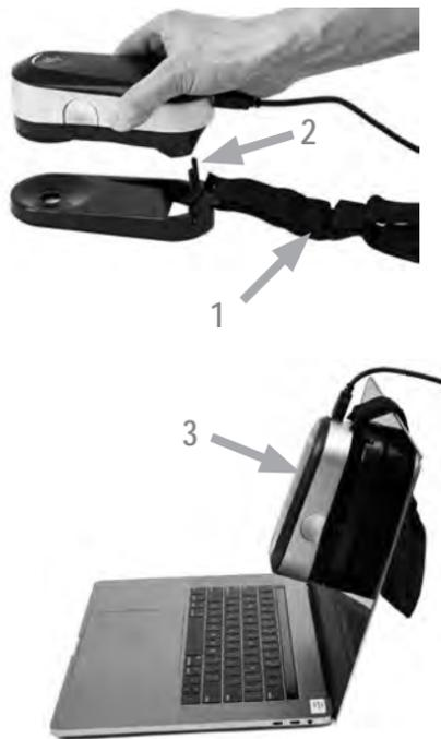
디스플레이 측정을 위해 i1Pro 3 장치를 준비하려면 i1Pro 3 장치를 디스플레이 홀더에 장착해야 합니다. 장치를 장착하기 전에 장치가 보정되었고 상태 표시기가 흰색으로 깜박이는지 확인하십시오.
