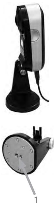
プロジェクターを測定するには、i1Pro 3 装置を三脚ホルダーにセットするか、さらには三脚ホルダーを標準タイプのねじ 2 本（未付属）を使用し三脚にセットすることもできます（1）。次に i1Pro 3 装置を三脚ホルダーに取り付けます。装置を取り付ける前に、キャリブレーションが完了しており、ステータス・インジケータの照明が白で点滅していることを確認してください。
