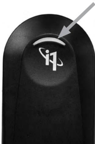
Il dispositivo i1Pro 3 è dotato di un indicatore di stato sul suo corpo superiore. L'indicatore di stato del dispositivo fornisce un feedback sullo stato attuale del dispositivo e guida l'utente attraverso il processo di misurazione.
