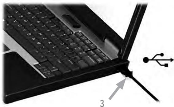
Prima di poter utilizzare il dispositivo o vedere il suo stato, è necessario installare l'applicazione software sul computer. Non collegare il cavo USB del dispositivo al computer finché non è stata installata l'applicazione software.
