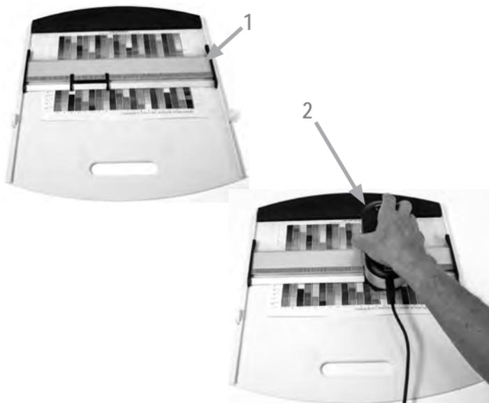
Pour prendre une mesure de balayage, vous devez tout d'abord monter l'i1Pro 3 sur la règle. Assurez-vous que votre instrument est étalonné et que l'indicateur d'état émet une lumière blanche clignotante avant de le monter.
