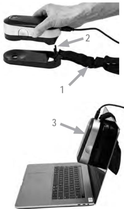
为了使 i1Pro 3 设备准备用于显示器测量，您需要在显示器支架上安装 i1Pro 3 设备。在安装设备之前，请确保设备已校准且状态指示灯闪烁白光。
