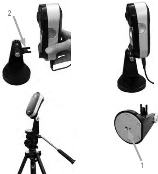
Per preparare il dispositivo i1Pro 3 per le misurazioni di proiettori, puoi utilizzare il dispositivo sul supporto per treppiede o montare il supporto su un proprio treppiede con una delle due viti standard di tua forniture (1). Dopodiché è necessario montare il dispositivo i1Pro 3 sul supporto per treppiede. Accertarsi che il dispositivo sia calibrato e l'indicatore di stato lampeggia bianco prima di montare il dispositivo.
