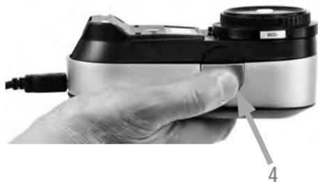
Antes de começar a medir, acople a cabeça de medição da luz ambiente na abertura de medição do dispositivo i1Pro 3. Caso você tenha vários dispositivos, certifique-se de que o número de série na cabeça de medição da luz ambiente combina com o número de série do seu dispositivo i1Pro 3. A cabeça de medição da luz ambiente também pode ser usada em conjunto com o suporte para tripé.
