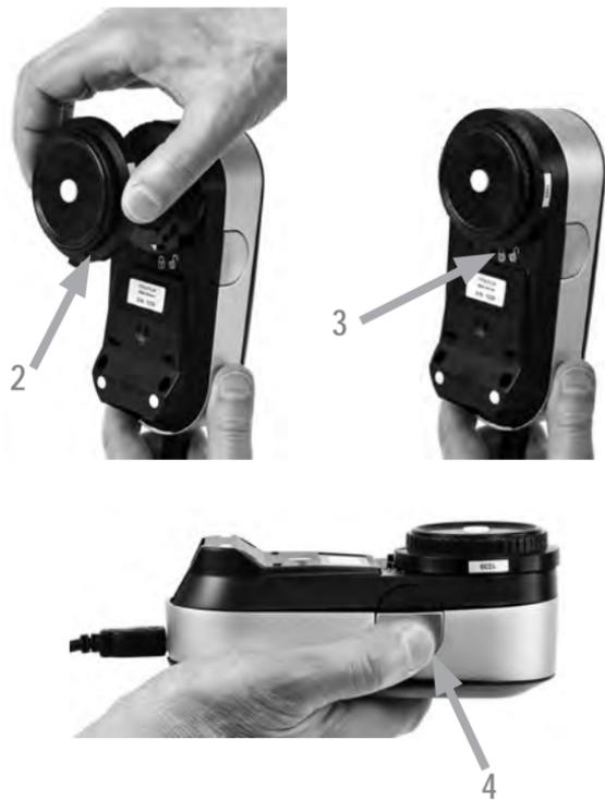
在开始测量之前，请将环境光源测量头安装到 i1Pro 3 设备上的限制孔径上。如果有多台设备，那么请确保环境光源测量头的序列号与 i1Pro 3 设备的序列号相匹配。环境光源测量头也可与三角支架相结合使用。
