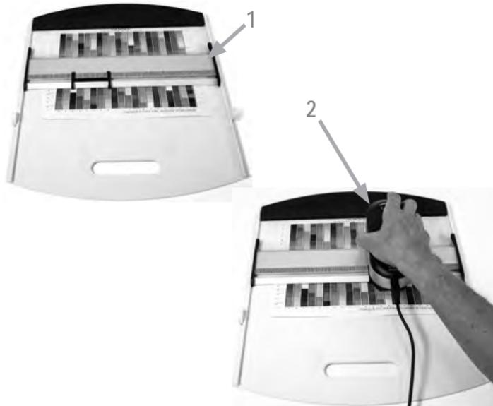
Vor der Streifenmessung müssen Sie das i1Pro 3 auf dem Lineal befestigen. Bitte achten Sie darauf, dass das Gerät kalibriert ist, und dass die Statusanzeige vor der Installation weiß pulsiert.
