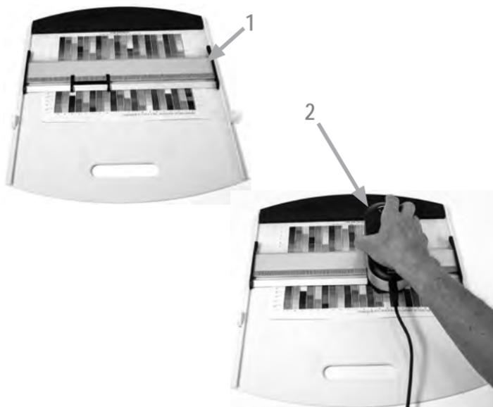
Para preparar o dispositivo i1Pro 3 para uma medição de digitalização você precisará montá-lo sobre o esquadro. Certifique-se de que o dispositivo esteja calibrado e que o indicador de estado esteja piscando na cor branco antes de montá-lo.
