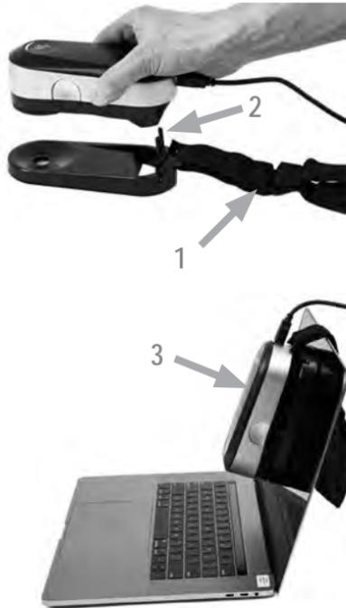
Vor der Monitormessung müssen Sie das i1Pro 3 auf der Monitorhalterung befestigen. Bitte achten Sie darauf, dass das Gerät kalibriert ist, und dass die Statusanzeige vor der Montage des Geräts weiß pulsiert.
