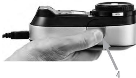
Bitte befestigen Sie vor der Messung den Umgebungslicht-Messkopf am Tubus des i1Pro 3. Falls Sie mehrere Geräte besitzen, dann überprüfen Sie bitte vor der Messung, ob die Seriennummer auf dem Umgebungslicht-Messkopf mit der des i1Pro 3 übereinstimmt. Der Umgebungslicht-Messkopf kann auch zusammen mit der Stativhalterung verwendet werden.
