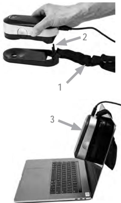
i1Pro 3 装置でディスプレイ測定を行うには、i1Pro 3 装置をディスプレイホルダーに取り付ける必要があります。装置を取り付ける前に、キャリブレーションが完了しており、ステータス・インジケータの照明が白で点滅していることを確認してください。
