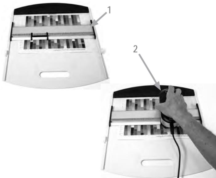
스캔 측정을 위해 iPro 3 장치를 준비하려면 iPro 3 장치를 눈금자에 장착해야 합니다. 장착하기 전에 장치가 보정되었고 상태 표시기가 흰색으로 깜박이는지 확인하십시오.
