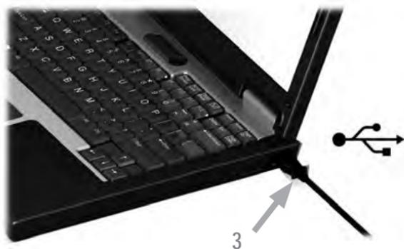
Antes de poder utilizar o dispositivo ou de ver seu estado, é necessário instalar o aplicativo no computador. Instale primeiro o aplicativo do programa e só depois disto conecte o cabo USB do dispositivo ao computador.
