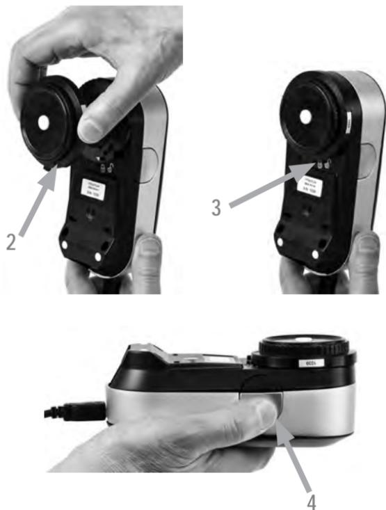
Prima di misurare, collocare la testina di misurazione della luce ambiente sull'apertura di misurazione del dispositivo i1Pro 3. Se si dispone di più dispositivi, assicurarsi che il numero di serie sulla testina di misurazione della luce ambiente corrisponde al numero di serie del dispositivo i1Pro 3. La testina di misurazione della luce ambiente può essere utilizzata anche in combinazione con il supporto per treppiede.
