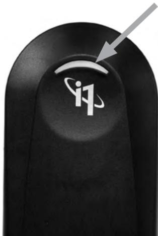
i1Pro 3 장치에는 하우징 상단에 장치 상태 표시기가 있습니다. 장치 상태 표시기는 장치의 현재 상태를 알려주고 측정 프로세스를 안내합니다.
