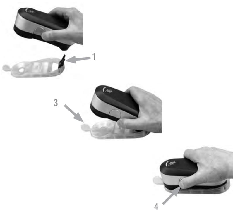
스팟 측정을 위해 i1 Pro 3 장치를 준비하려면 i1 Pro 3 장치를 포지셔닝 타겟에 장착해야 합니다. 장치를 장착하기 전에 장치가 보정되었고 상태 표시기가 흰색으로 깜박이는지 확인하십시오. 스팟 측정 프로세스에 대한 자세한 내용은 측정 소프트웨어의 사용 설명서를 참조하십시오.
