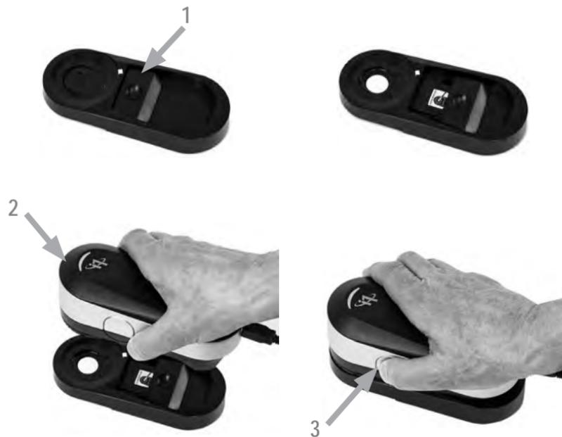
Si vous possédez plusieurs instruments, vérifiez que le numéro de série figurant à l'avant et à l'arrière de la plaque d'étalonnage correspond bien au numéro de série de votre i1Pro 3. Reportez-vous au guide de l'utilisateur de votre logiciel de mesure pour obtenir davantage d'informations sur le processus d'étalonnage.
