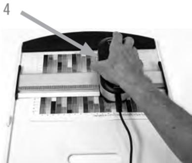
1. Accertarsi che il dispositivo sia calibrato e l'indicatore di stato lampeggia bianco prima di montare il dispositivo.
