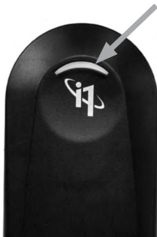
O dispositivo i1Pro 3 vem equipado com um indicador de estado na parte de cima do corpo do aparelho. O indicador de estado fornece informações sobre o estado atual do dispositivo e dá orientações no decorrer do processo de medição.
