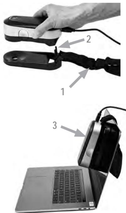
Para preparar o dispositivo i1Pro 3 para a medição de uma tela você precisará montá-lo sobre o suporte de telas. Certifique-se de que o dispositivo esteja calibrado e que o indicador de estado esteja piscando na cor branco antes de montar o dispositivo.
