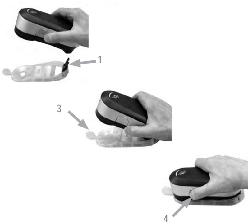
Para preparar o dispositivo i1Pro 3 para uma medição pontual, você precisará montá-lo sobre o alvo de posicionamento. Certifique-se de que o dispositivo esteja calibrado e que o indicador de estado esteja piscando na cor branco antes de montar o dispositivo. Consulte o guia do usuário do seu aplicativo de medição para obter informações adicionais sobre o processo de medição pontual.
