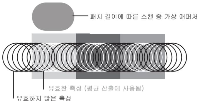
스캔 측정 중에 i1Pro 3 장치는 초당 400 회의 측정을 수행합니다. 장치는 자동 패치 감지를 통해 패치에서 측정된 사용 가능한 측정치와 두 패치 사이에서 측정된 사용 불가능한 측정치를 식별합니다. 패치의 유효한 측정치들의 평균을 산출하여 장치가 평균 결과를 소프트웨어에 보고합니다. 이 기술 덕분에 i1Pro 3 장치의 가상 애퍼처는 패치의 길이에 맞춰집니다. 최상의 측정 결과를 얻으려면 테스트 차트의 패치 길이를 프린터의 해상도에 따라 선택해야 합니다. 경우에 따라 패치 폭을 늘리면 보다 정확한 결과를 얻을 수 있습니다.
