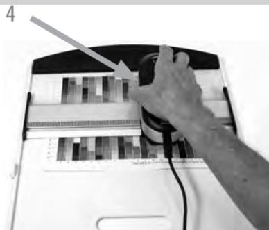
1. 装置を取り付ける前に、キャリブレーションが完了しており、ステータス・インジケータの照明が白で点滅していることを確認してください。
