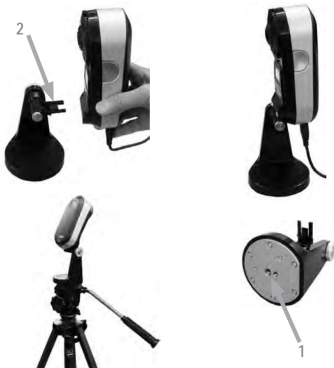
Para preparar o dispositivo i1Pro 3 para a medição de telas de projetores, pode utilizar o dispositivo sobre o suporte para tripé ou montar o suporte sobre um tripé com um dos dois parafusos padrões do seu fornecimento (1). A seguir, será necessário montar o dispositivo i1Pro 3 sobre o suporte para tripé. Certifique-se de que o dispositivo esteja calibrado e que o indicador de estado esteja piscando na cor branco antes de montar o dispositivo.
