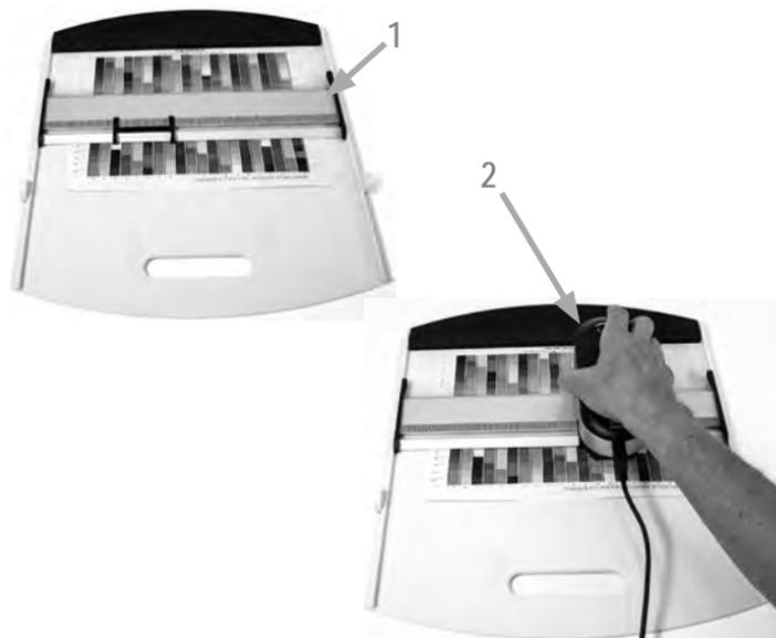
Per preparare il dispositivo i1Pro 3 per una misurazione da scansione, è necessario montare il dispositivo i1Pro 3 sul righello. Accertarsi che il dispositivo sia calibrato e l'indicatore di stato lampeggia bianco prima di montare il dispositivo.
