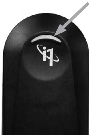
i1Pro 3 装置は、本体上部に装置ステータス・インジケータが備わっています。装置のステータス・インジケータは、装置の現在の状態と測定手順を表示します。
