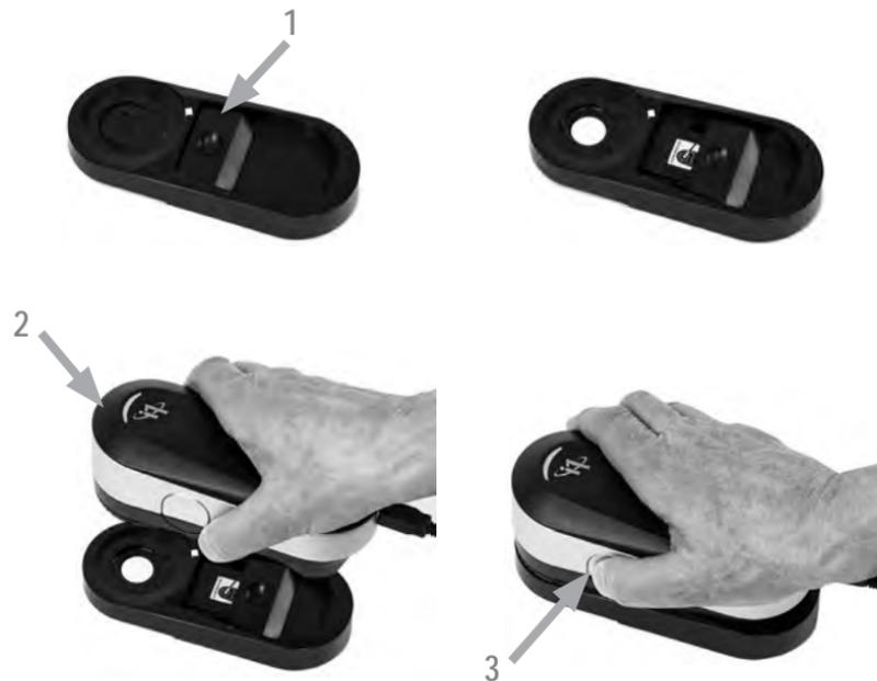
Se si dispone di più dispositivi, assicurarsi che il numero di serie sulle parti anteriore e posteriore della piastra di calibrazione corrisponde al numero di serie del dispositivo i1Pro 3. Per ulteriori informazioni sul processo di calibrazione, vedere il manuale d'uso del software di misurazione.
