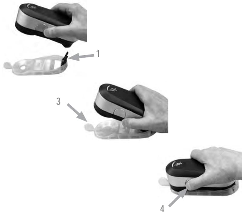
Per preparare il dispositivo i1Pro 3 per una misurazione spot, è necessario montare il dispositivo i1Pro 3 sul target di posizione. Accertarsi che il dispositivo sia calibrato e l'indicatore di stato lampeggia bianco prima di montare il dispositivo. Per ulteriori informazioni sul processo di misurazione spot, vedere il manuale d'uso del software di misurazione.
