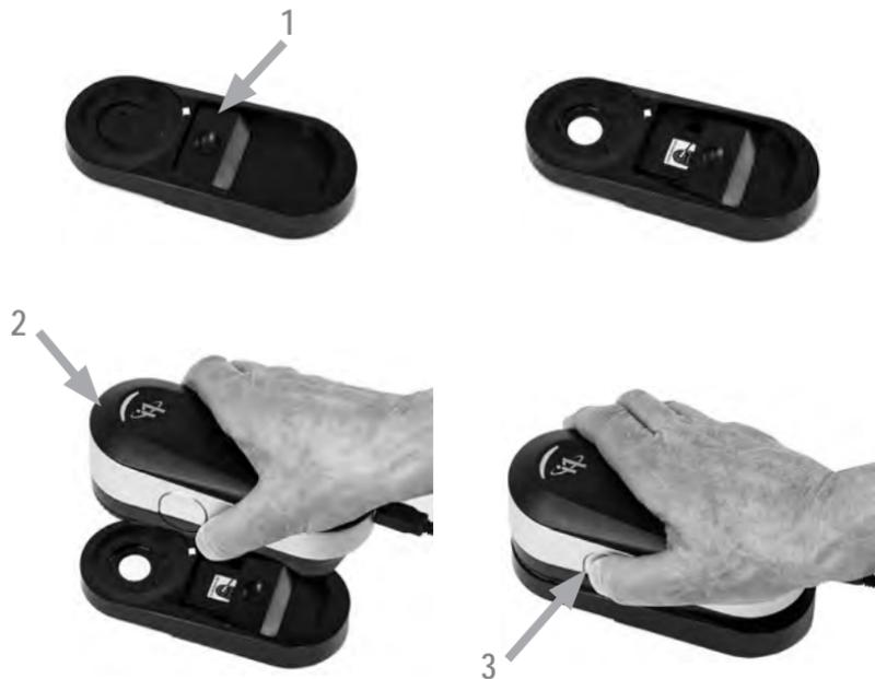
如果您拥有多台设备，请确保校准板正面和背面的序列号与 i1Pro 3 设备的序列号相匹配。有关校准过程的详情，请参阅测量软件用户指南。
