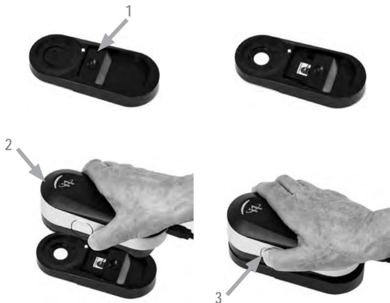
Si tiene varios dispositivos, asegúrese de que el número de serie en las partes anterior y posterior de la placa de calibración coincide con el número de serie del dispositivo i1Pro 3. Consulte el manual del usuario del software de medición para obtener más información sobre el proceso de calibración.
