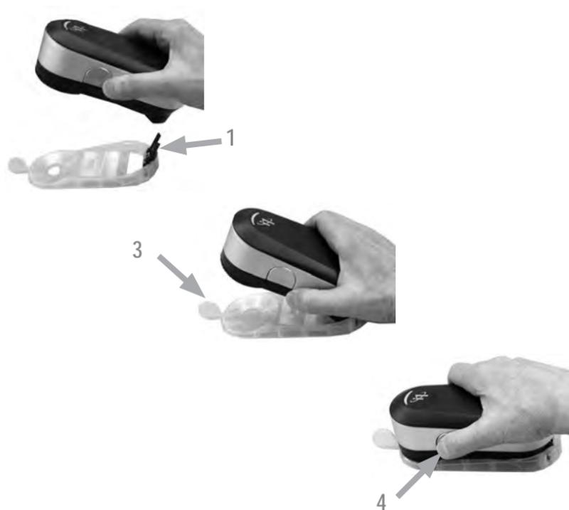
Para preparar el dispositivo i1Pro 3 para una medición de punto, es necesario montarlo en el objetivo de posicionamiento. Asegúrese de que el dispositivo esté calibrado y que el indicador de estado esté pulsando en color blanco antes de montar el dispositivo. Consulte el manual del usuario del software de medición para obtener más información sobre el proceso de medición de punto.
