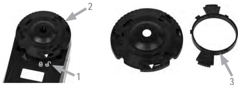
若要使 i1Pro 3 在使用寿命内保持其测量性能，必须遵守一些规则，并定期清洁一些对于测量性能很关键的零件。洁净的白色校准片和防护玻璃对于测量精准与否绝对是至关重要的。
