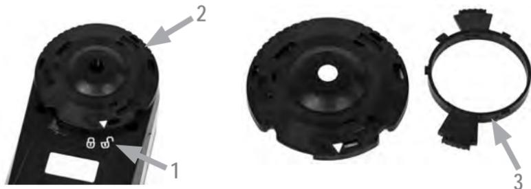
Per mantenere la prestazione colorimetrica del dispositivo i1Pro 3 durante sua durata, è importante osservare alcune regole e di pulire periodicamente alcune parti che sono fondamentali per la prestazione delle misurazioni. Una ceramica bianca di riferimento e un vetro di protezione puliti sono essenziali per fornire misurazioni esatte.
