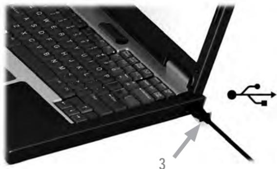
装置を使用またはステータスを表示する前に、ソフトウェアをコンピュータにインストールする必要があります。ソフトウェアのインストールが完了するまで、装置の USB ケーブルはコンピュータに挿入しないでください。
