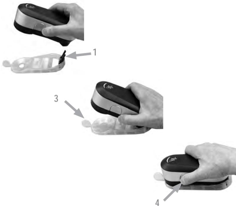
为了使 i1Pro 3 设备准备用于专色测量，您需要在定位目标上安装 i1Pro 3 设备。在安装设备之前，请确保设备已校准且状态指示灯闪烁白光。有关专色测量过程的详情，请参阅测量软件用户指南。
