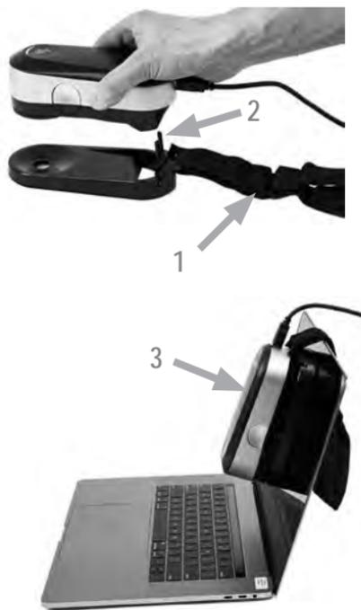
Per preparare il dispositivo i1Pro 3 per una misurazione display, è necessario montare il dispositivo i1Pro 3 sul supporto per display. Accertarsi che il dispositivo sia calibrato e l'indicatore di stato lampeggia bianco prima di montare il dispositivo.
