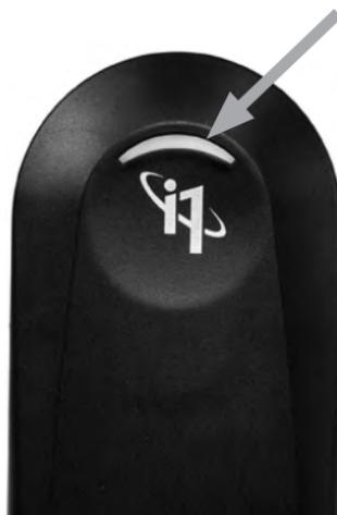
Auf der Oberseite des i1Pro 3-Gehäuses befinden sich die Statusanzeige. Diese LED zeigt die verschiedenen Gerätezustände an und leitet Sie durch den Messvorgang.
