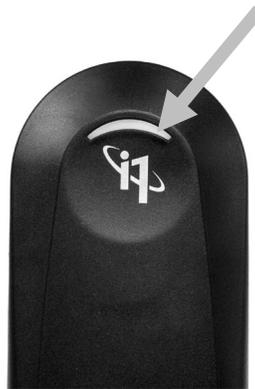
Pour éviter que l'indicateur d'état de l'instrument n'interfère avec le processus de mesure, l'indicateur est éteint pendant la mesure.
