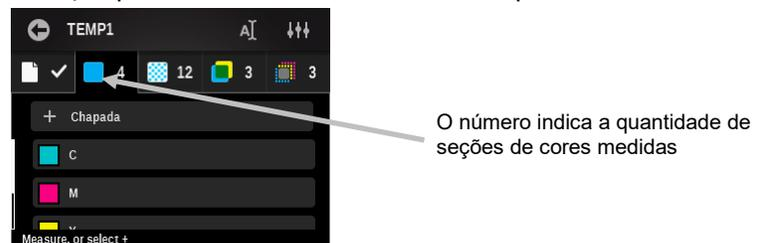
4. É possível medir em qualquer ordem os degradês definidos para as cores de quadricromia medidas. O instrumento detectará automaticamente o degradê medido. Neste exemplo, temos
