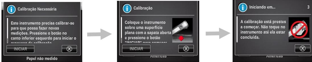
Uma calibração será também necessária quando o seletor da Condição de Medição tiver sua posição alterada e não tiver sido feita uma calibração para tal posição ou a mesma estiver vencida. Neste caso, toque no botão INICIAR na tela para começar o procedimento e siga as demais instruções nela fornecidas.
