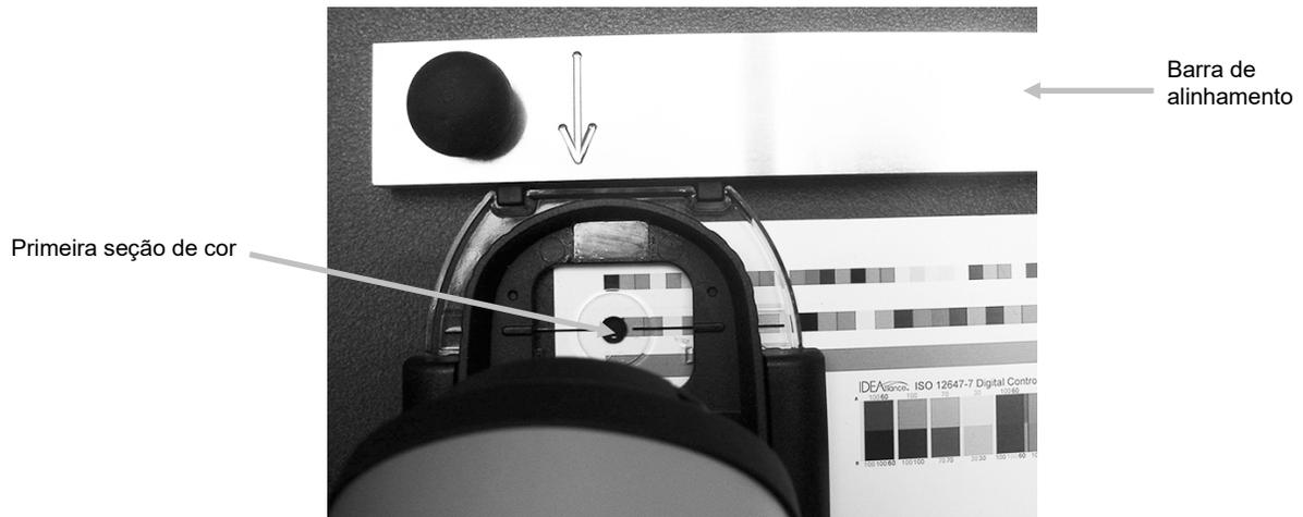
3. Posicione a abertura de medição do instrumento sobre a última seção de cor da barra e ajuste a barra de alinhamento até que ela encoste nos batentes frontais.
