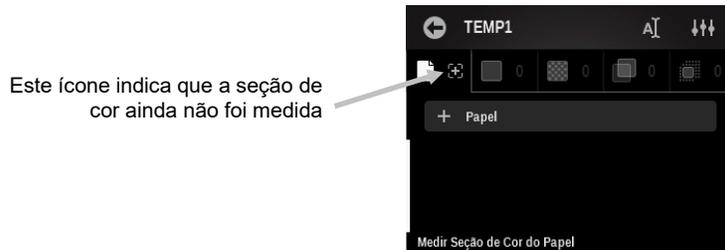
1. Meça a seção de cor do papel utilizando a tela principal Editar Modelo de Tarefa. A seção de cor do papel aparece após a medição.
