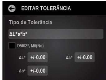
2. Toque no botão Tipo de Tolerância e selecione Nenhuma,  $\Delta L^*a^*b^*$ ,  $\Delta L^*C^*H^*$ , Método de Delta E Ativo ou  $\Delta$ Densidade para a tolerância.
