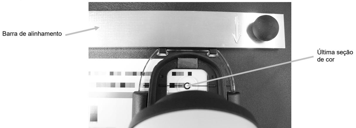
4. Agora, a abertura do instrumento deve rastrear o centro da barra de cores à medida que o instrumento é deslizado ao longo da folha de impressão.
