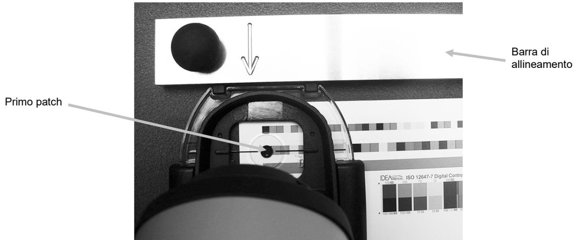
3. Collocare l'apertura dello strumento sopra l'ultimo patch della barra di colori e regolare la barra di allineamento fino a quando non tocchi i battenti frontali.
