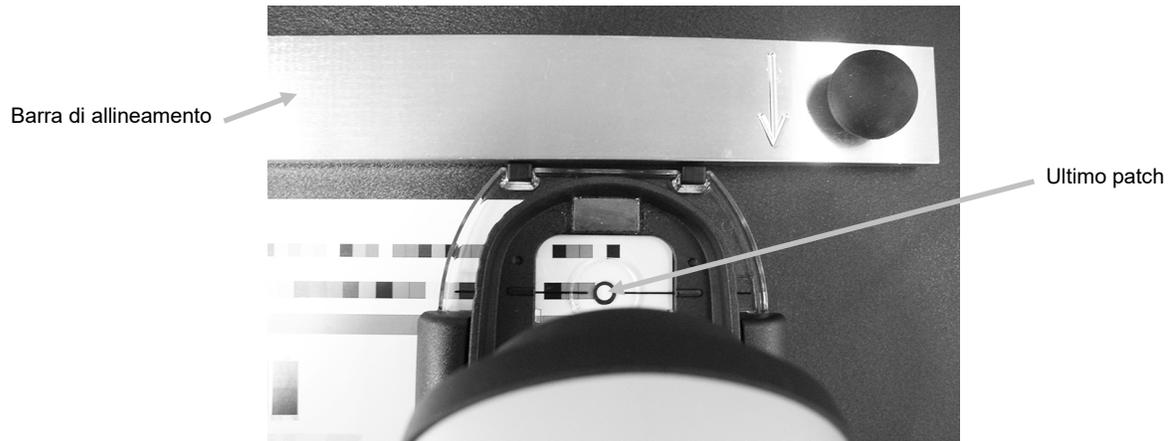
4. L'apertura dello strumento dovrebbe rintracciare il centro della barra di colori mentre si sposta lo strumento sul foglio di stampa.
