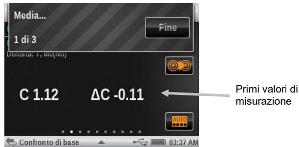
4. Collocare lo strumento sulla seconda area del campione e effettuare una misurazione. Dopo la misurazione, lo strumento visualizza "2 di 3" sulla schermata, indicando ancora una misurazione è richiesta per i risultati.
