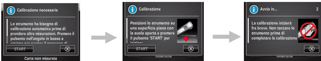
Occorre fare una calibrazione anche quando il commutatore della condizione di misurazione è modificato e una calibrazione non è stata eseguita o è scaduta in quella posizione. In questo caso, scegliere il pulsante INIZIO sullo schermo per iniziare la procedura e seguire le istruzioni sullo schermo.
