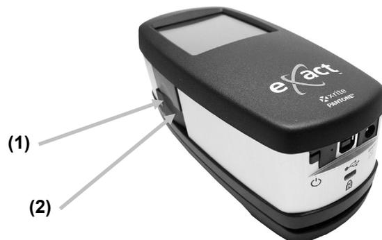
Il perno di bloccaggio della base target viene anche utilizzato per bloccare lo strumento contro la finestra del target quando le misurazioni sono attivate dal software.
