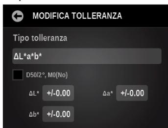
2. Scegliere il pulsante Tipo di tolleranza e selezionare Nessuna,  $\Delta L^*a^*b^*$ ,  $\Delta L^*C^*H^*$ , Metodo Delta E attivo o  $\Delta$ Densità per la tolleranza.
