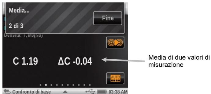
5. Collocare lo strumento sulla terza area del campione e effettuare una misurazione. Dopo la misurazione, lo strumento visualizza i valori medi dei dati.
