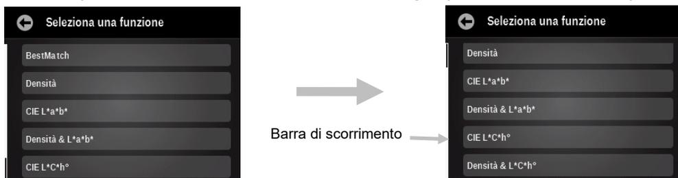
Lo scorrimento può verificarsi anche sulle schermate delle opzioni in cui valori o parametri vengono selezionati. Nell'esempio riportato di seguito, ruotare la rotellina su o giù per selezionare l'illuminante desiderato.
