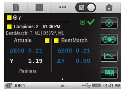
È possibile attivare la compensazione del substrato anche dopo una misurazione della carta durante job G7.
