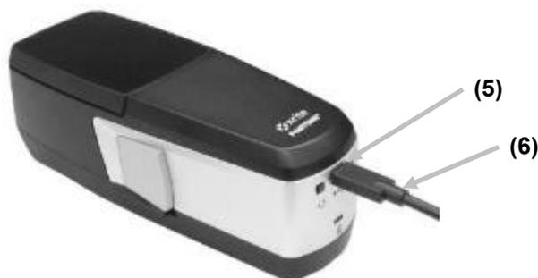
**NOTA:** Se il dispositivo è collegato direttamente tramite un cavo USB e posizionato sulla base d'appoggio collegata, lo strumento viene caricato in modalità senza fili e NON tramite USB. La base d'appoggio ha la priorità.
