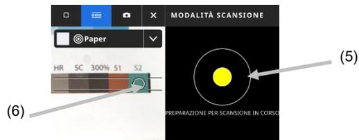
7. Visualizzando la schermata di target, posizionare il cerchio (reticolo) (6) nella finestra di target sopra il primo patch della barra di colori.
