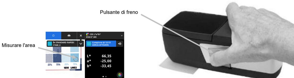
6. Premere il pulsante Misura di nuovo per prendere la misurazione. I dati di misurazione vengono visualizzati sul display insieme a un patch di colore simulato. Continuare con le altre misurazioni, se necessario.
