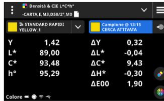
**NOTA:** Se la libreria di colori selezionata ha tolleranze incluse negli standard, le icone di stato vengono visualizzati sul patch dello standard e accanto al valore  $\Delta E$  sulle misurazioni. Vedere gli esempi di seguito.
