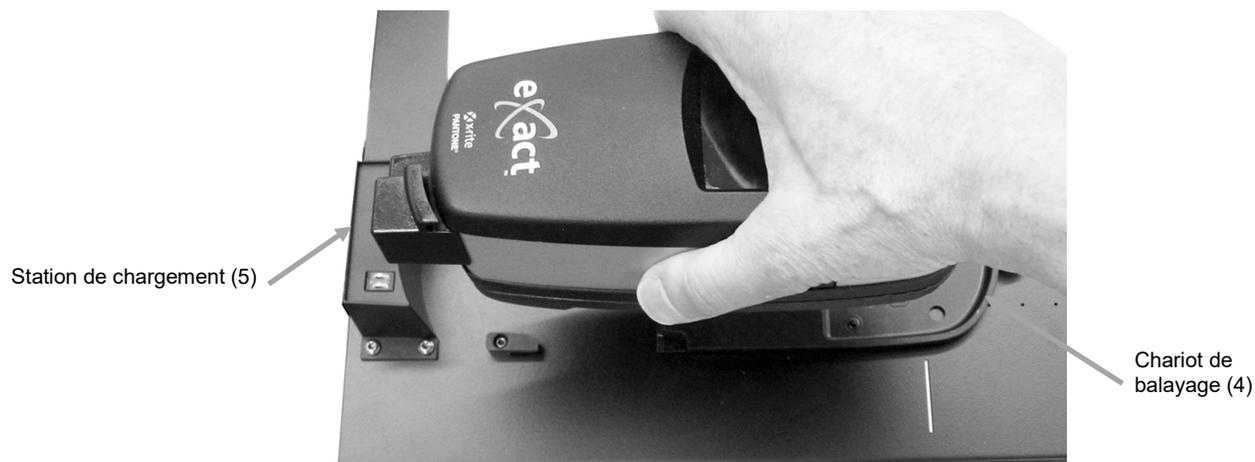
7. Fixez l'instrument eXact au chariot de balayage en faisant pivoter le bras de verrouillage (6) dans le sens inverse des aiguilles d'une montre jusqu'à ce qu'il s'arrête. Ce dispositif maintient l'instrument en place pendant le balayage.
