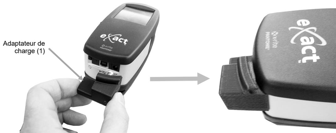
**REMARQUE :** Si vous n'utilisez pas la fonction Bluetooth, faites passer le câble USB de l'instrument eXact dans la rainure située sur l'adaptateur de charge. Cela permet d'éviter que le câble n'interfère avec la station de charge et la piste pendant l'utilisation. Ce câble est distinct du câble USB du système eXact Auto-Scan précédemment installé. Branchez la fiche carrée du câble USB à l'arrière de l'instrument. Branchez le câble USB dans un port disponible sur votre ordinateur.
