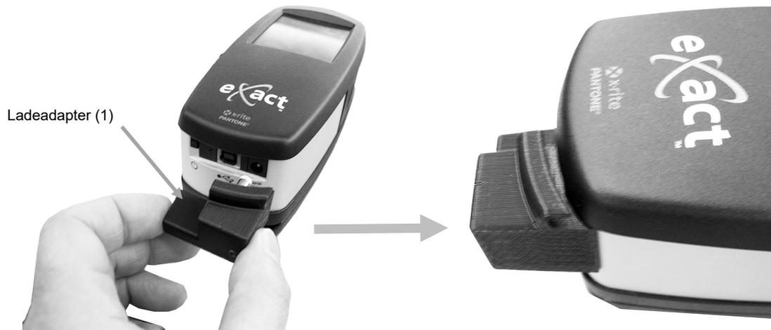
**HINWEIS:** Wenn Sie Bluetooth nicht verwenden, dann führen Sie das USB-Kabel des Geräts durch die Kabelführung oben im Adapter. Die Führung verhindert Probleme mit dem Kabel, wenn Sie die Schiene zum Scan verwenden. Dies ist nicht das gleiche USB-Kabel, das zuvor in der Einrichtung beschrieben wurde. Verbinden Sie das quadratische Ende des USB-Kabels mit der Rückseite des Geräts. Verbinden Sie das USB-Kabel mit einer freien USB-Schnittstelle an Ihrem Computer.
