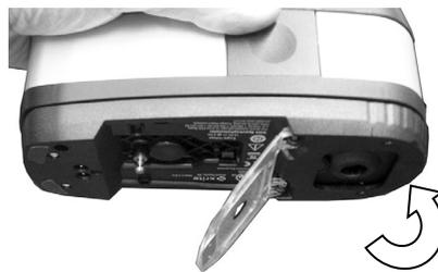
3. Platzieren Sie das Zielfenster auf der zu messenden Probe. Die Öffnung des Zielfensters sollte vollständig mit der Probenfarbe ausgefüllt sein.
