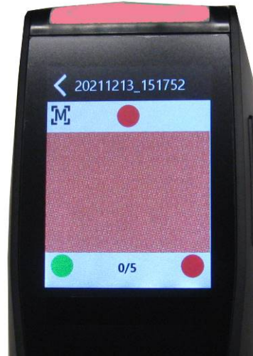
Exemplo 2: Dois sensores de pressão não estão em contato e a medição não pode ser acionada
