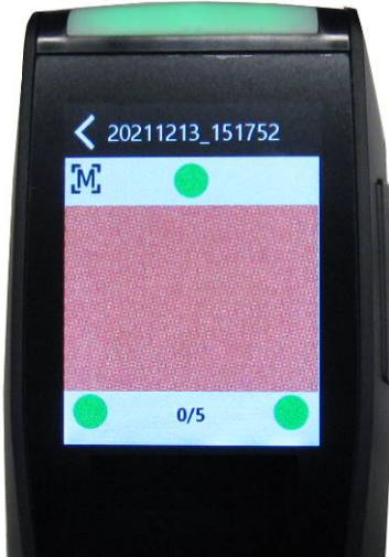
Exemplo 1: Todos os sensores de pressão estão corretamente em contato e uma medição pode ser acionada.
