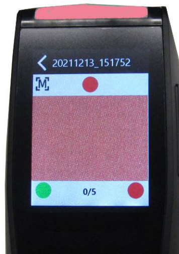
예제 2: 두 개의 압력 센서가 적절히 접촉하지 않으면 측정을 시작할 수 없습니다.
