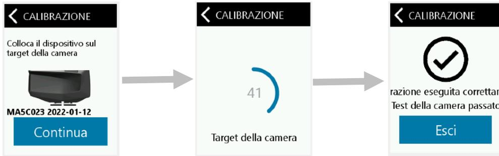
6. Il dispositivo esegue un autotest dopo la calibrazione utilizzando il bianco esterno. Rimuovere il dispositivo al termine dell'autotest.
