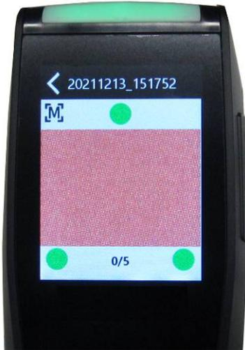
Esempio 1: indica che i tre sensori di pressione sono in contatto correttamente e una misurazione ora può essere eseguita.
