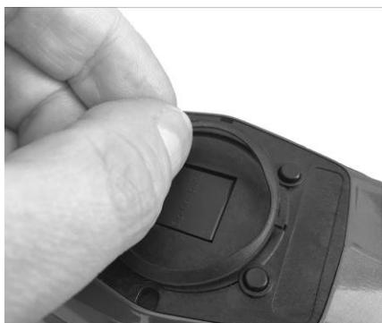
3. Premere la nuova guarnizione a tenuta di luce nel suo alloggiamento fino a quando tutte le linguette di gomma non siano inserite correttamente e la guarnizione non sia posizionata in modo piano.
