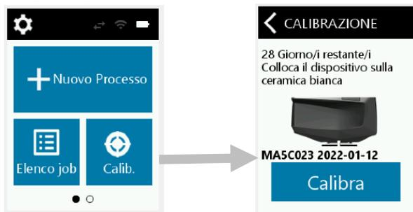
2. Separare il riferimento di calibrazione e posizionare la porta di misurazione del dispositivo sulla ceramica bianca come mostrato nell'immagine seguente. Assicurarsi che i due perni di allineamento si inseriscano
