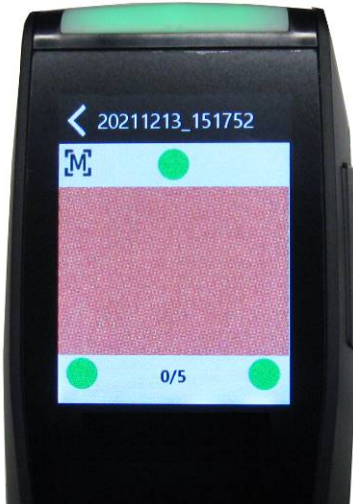
Exemple 1 : les capteurs de pression sont correctement activés et une mesure peut désormais être déclenchée.
