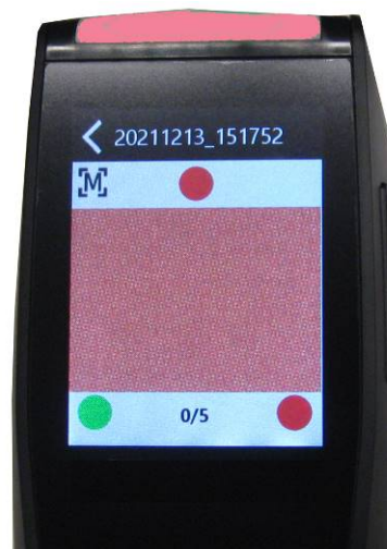
Exemple 2 : deux capteurs de pression ne sont pas activés et la mesure ne peut pas être déclenchée
