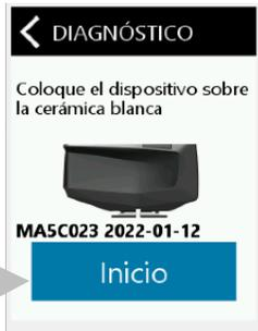
4. Una vez completada la calibración con la cerámica blanca, coloque el dispositivo sobre el objetivo de prueba de cámaras como se explica en la sección Modo de calibración y puntee en el botón **Inicio**.
