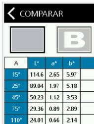
5. Después de la medición, puntee en **B** en la pantalla Comparar. El dispositivo pasa a modo de orientación automáticamente.
