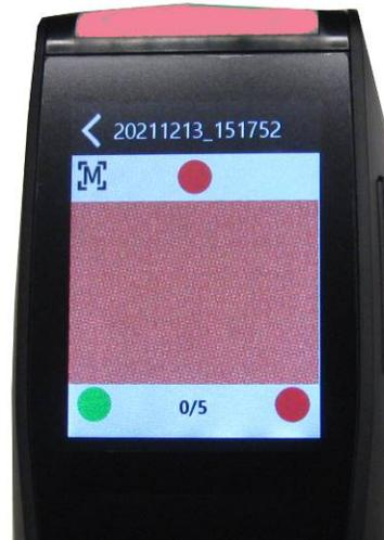
Ejemplo 2: Dos sensores de presión no están en contacto y la medición no se puede activar
