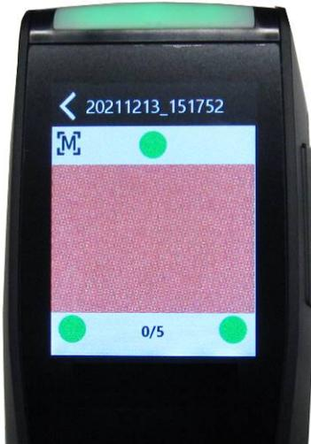
Ejemplo 1: indica que todos los tres sensores de presión se activan correctamente y ahora es posible realizar una medición.
