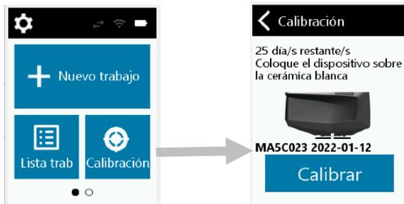
2. Separe la referencia de calibración y coloque el puerto de medición del dispositivo sobre la cerámica blanca como se muestra en la imagen a continuación. Asegúrese de que los dos pernos de alineación se inserten en las aberturas de la referencia de cerámica blanca. **Nota:** Los pernos sólo se insertan en una dirección. Asegúrate de tener el dispositivo alineado correctamente. Desconecte el dispositivo del cable USB mientras calibra el dispositivo.
