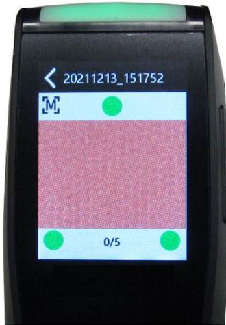
範例 1：所有接觸式感應器接觸正確，而且可觸發測量
