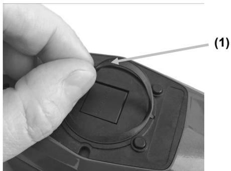
2. 將新的光封墊定位在測量連接埠周圍的凹陷區域上。
