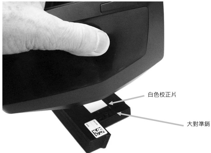
3. 就緒時，點選 **Calibrate** (校正)。在整個測量過程中請勿觸摸裝置。
