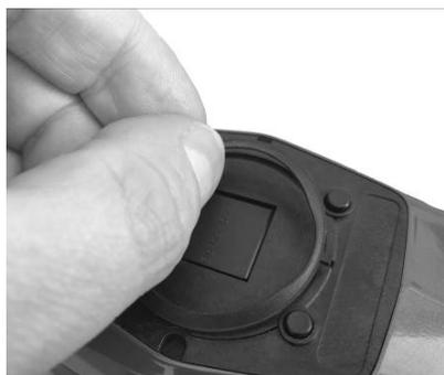
3. 將新的光封墊按入定位，直到所有橡膠片都正確插入且光封墊平放。
