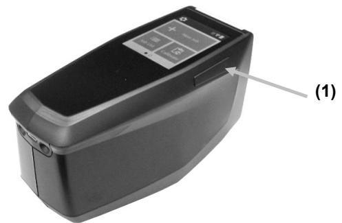
電源開啟後，裝置將進行診斷測試。狀態 LED 和螢幕亮起白色，然後主畫面出現啟動畫面。此啟動序列需要幾秒鐘才能完成。
