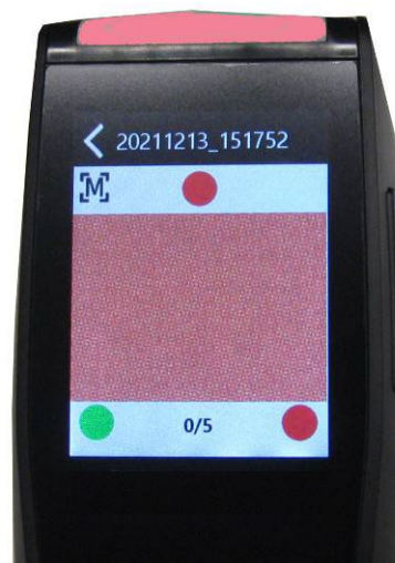
示例 2：两枚压力传感器尚未接触，无法触发测量
