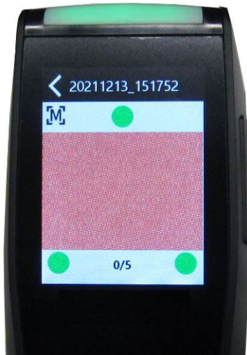
示例 1：所有压力传感器均正确接触，触发测量
