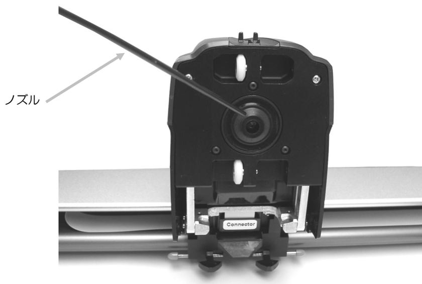
3. ヘッドを測定位置に下げ、ロック解除ピンを元の位置に戻してください。
