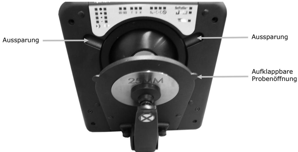
**Abbildung 1. Öffnen der aufklappbaren Probenöffnung**
