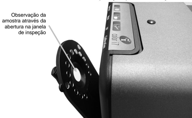
**Figura 2. Observação da amostra através da abertura na janela de inspeção**
