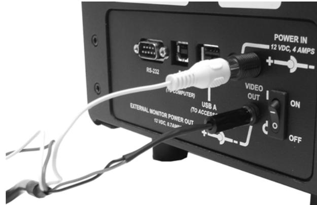
**Figura 4. Conexões do cabo do monitor**
