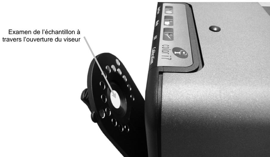
**Figure 2. Examen de l'échantillon à travers l'ouverture du viseur**
