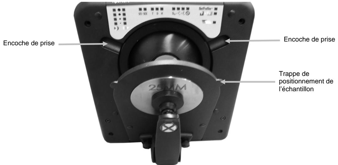
**Figure 1. Ouverture de la trappe articulée de positionnement de l'échantillon**
