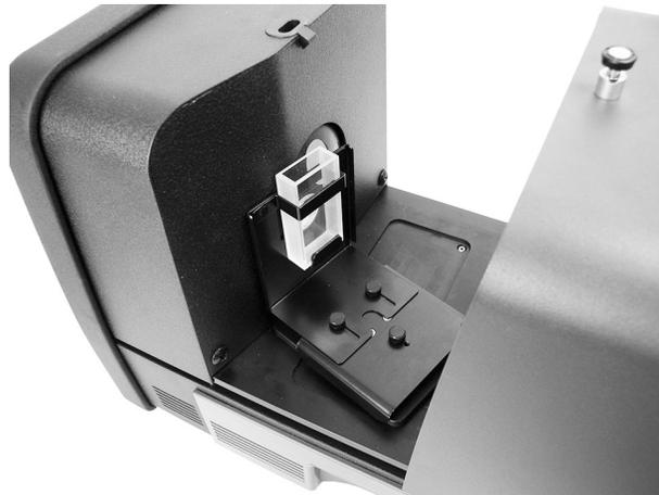
5. Inicie a medição selecionando "Measure Standard" (Medir Padrão) ou "Measure Trial" (Medir Amostra) no aplicativo do programa, ou pressione o botão apropriado de medição no painel frontal.
