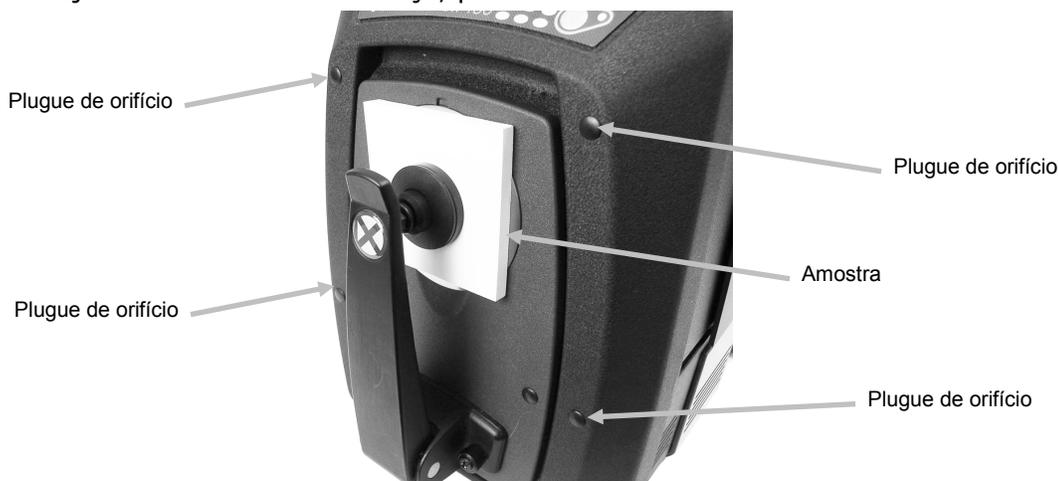
6. Use a tela do computador ou a portinhola suspensa para ver a amostra e ajustar a área alvo de medição da amostra.
