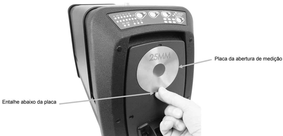
3. Na gaveta de acessórios, localize a placa a ser instalada e encaixe-a na abertura sobre o perímetro da portinhola de amostras. A placa mantém-se no lugar por meio de ímãs.
