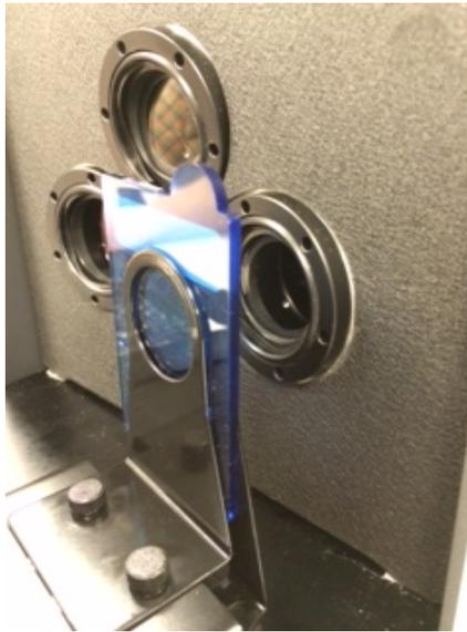
7. Uma vez posicionada corretamente, aperte os parafusos manualmente e feche a tampa do compartimento de transmitância.
