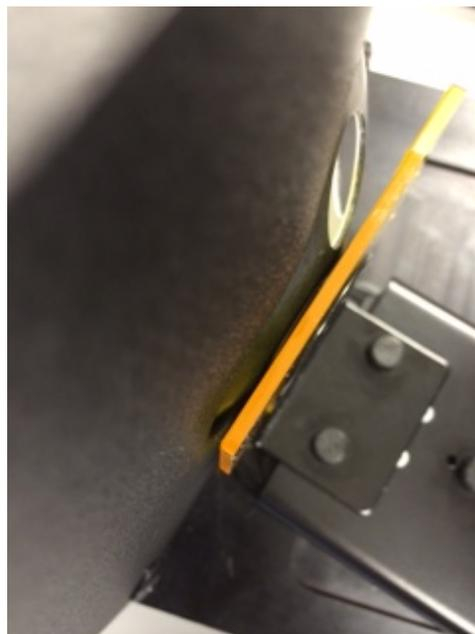
**Porta-amostras de transmitância com a amostra posicionada na esfera (medição da transmitância total) para as aberturas de 25 mm, 17 mm, 10 mm e 6 mm**
