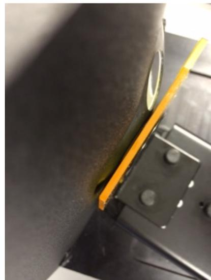
9. Uma vez posicionada corretamente, aperte os parafusos manualmente e feche a tampa do compartimento de transmitância.
