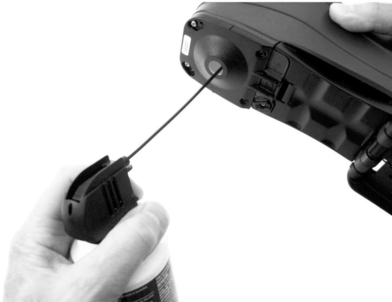
**WICHTIG:** Halten Sie Sprühdosen mit Druckluft beim Reinigen aufrecht, drehen Sie sie nicht um. Sie können sonst die Optik beschädigen.
