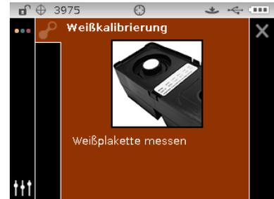
6. Drücken Sie das Gerät solange gegen den Fuß, bis im Display angezeigt wird, dass der Messvorgang abgeschlossen ist. Lassen Sie das Gerät wieder los.
