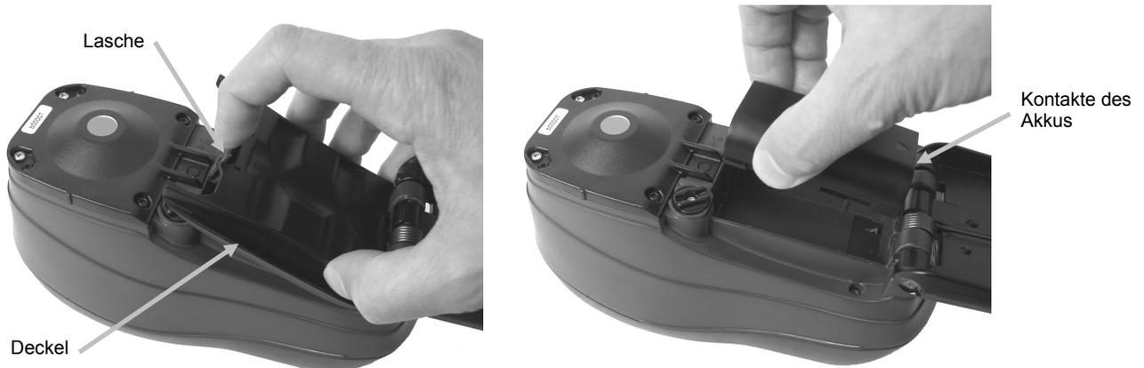
5. Setzen Sie den Deckel wieder ein. Schieben Sie hierzu das hintere Ende zuerst ein und drücken Sie dann den Deckel nach unten, bis der Deckel einschnappt.
