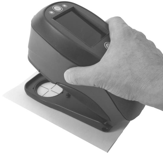
3. Drücken Sie das Gerät solange gegen den Fuß, bis im Display angezeigt wird, dass der Messvorgang abgeschlossen ist.
