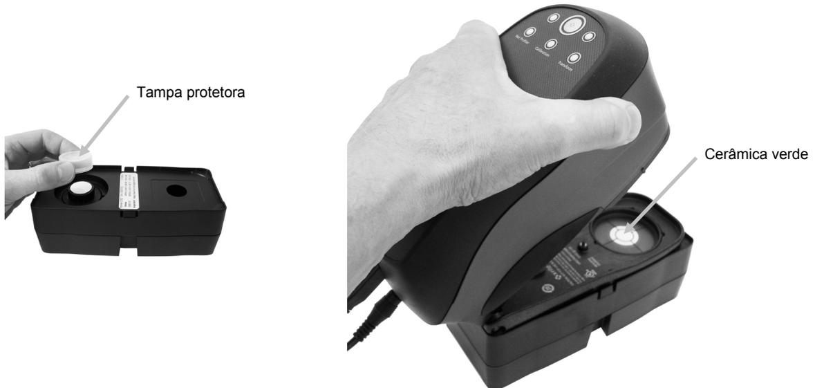
5. Pressione o instrumento firmemente contra a sapata. Mantenha-o pressionado até que os indicadores de estado da medição mudem para a cor âmbar e, em seguida, para a cor verde. O indicador da calibração deveria mudar para vermelho.
