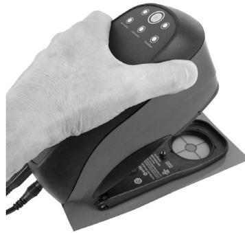
3. Pressione o instrumento firmemente contra a sapata; os indicadores de medição mudam para a cor âmbar. Mantenha-o pressionado até que os indicadores de estado da medição mudem para a cor verde seguida por um som de bip. Isso indica que a medição foi concluída com êxito.
