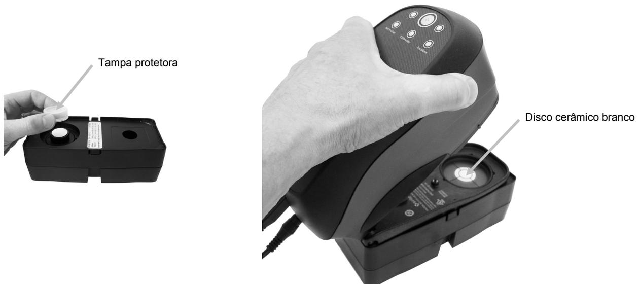
4. Pressione o instrumento firmemente contra a sapata. Mantenha-o pressionado até que os indicadores de estado da medição mudem para a cor âmbar e, em seguida, para a cor verde. O indicador da calibração deveria mudar para vermelho.
