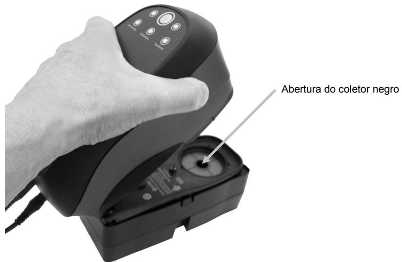
8. Pressione o instrumento firmemente contra a sapata. Mantenha o instrumento pressionado até que os indicadores de estado da medição mudem para as cores âmbar e verde em sequência e, em seguida, o indicador da calibração mude para a cor verde. Isso indica que o procedimento de calibração foi concluído com êxito.
