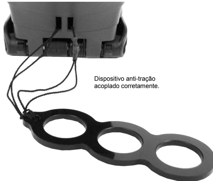
6. Passe o plugue do adaptador de voltagem CA e o plugue USB através dos três anéis do dispositivo anti-tração.
