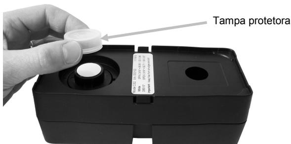
2. **Importante:** Sempre pegue o disco cerâmico pelas bordas, tendo cuidado de não tocar na superfície branca ou verde. Pressione o disco cerâmico para baixo e gire-o em sentido anti-horário até que pare. Levante e retire o disco cerâmico da base.
