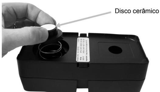
3. Limpe o disco usando uma solução de água morna e detergente suave. Enxague-o cabalmente com água morna e seque-o bem com um pano que não solte felpas. Não use nenhum tipo de solventes ou produtos de limpeza.
