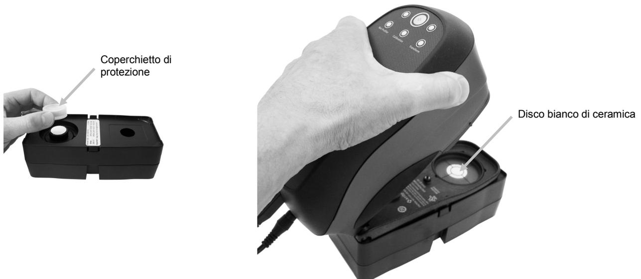
4. Premere lo strumento con fermezza contro la suola. Tenerlo fermo fino a quando gli indicatori di stato della misurazione cambiano al colore ambra e, di seguito, al colore verde. L'indicatore di calibrazione dovrebbe cambiare al rosso.
