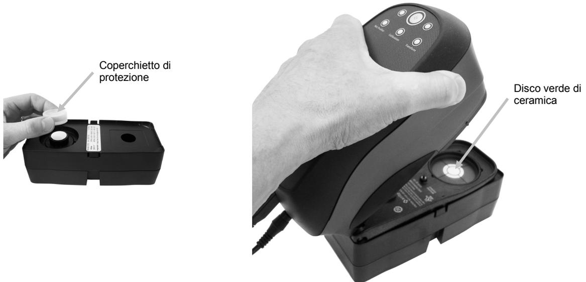
5. Premere lo strumento con fermezza contro la suola. Tenerlo fermo fino a quando gli indicatori di stato della misurazione cambiano al colore ambra e, di seguito, al colore verde. L'indicatore di calibrazione dovrebbe cambiare al rosso.
