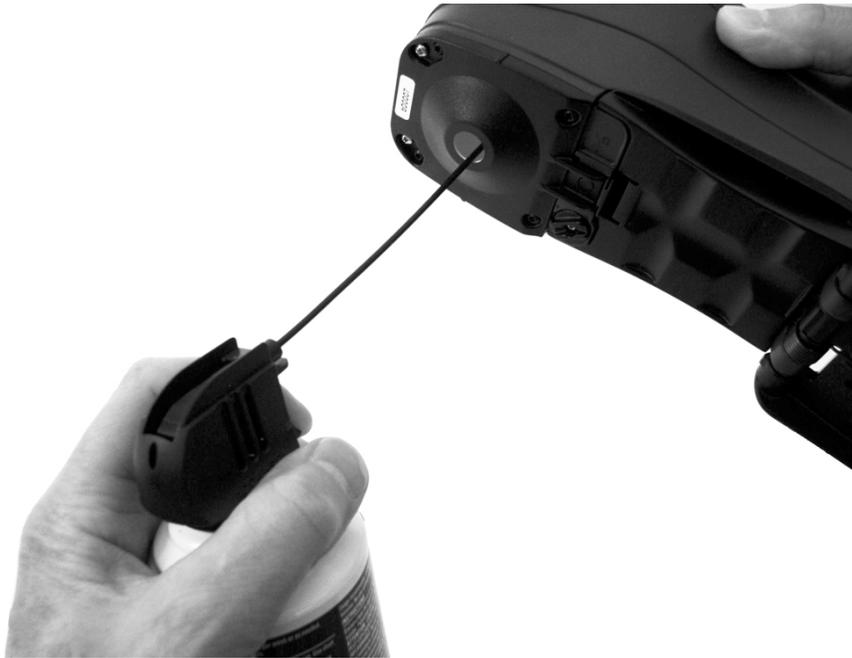
**IMPORTANTE:** se una bomboletta di aria compressa è utilizzata, non invertire o inclinare la bomboletta durante l'uso. Ciò potrebbe causare danni all'area ottica.
