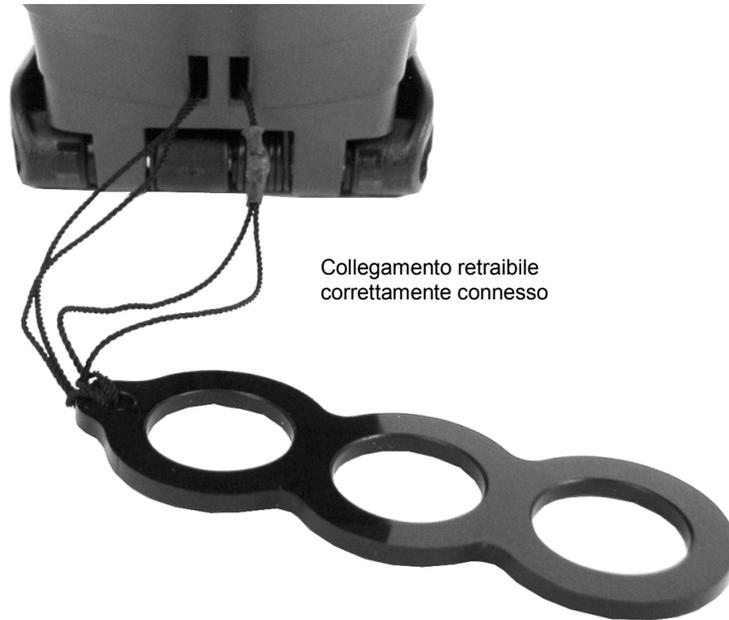
6. Passare la spina dell'adattatore CA e la spina USB attraverso i 3 anelli del dispositivo anti-trazione.
