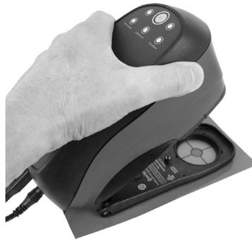
3. Premere lo strumento con fermezza contro la suola. Gli indicatori di misurazione cambiano al colore ambra. Tenerlo fermo fino a quando gli indicatori di stato della misurazione cambiano al colore verde seguito da un bip udibile. Questa è un'indicazione che la misurazione è riuscita.
