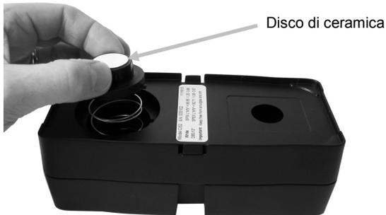
3. Pulire il disco utilizzando sapone neutro e soluzione di acqua tiepida. Sciacquare accuratamente con acqua tiepida e asciugare con un panno pulito. Non utilizzare solventi o detersivi di alcun tipo.
