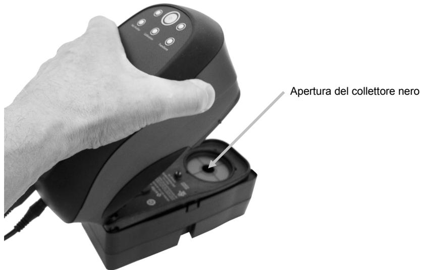
8. Premere lo strumento con fermezza contro la suola. Tenerlo fermo fino a quando gli indicatori di stato della misurazione cambiano al colore ambra e, di seguito, al colore verde, e l'indicatore della calibrazione cambia al colore verde. Questa è un'indicazione che la procedura di calibrazione è riuscita.
