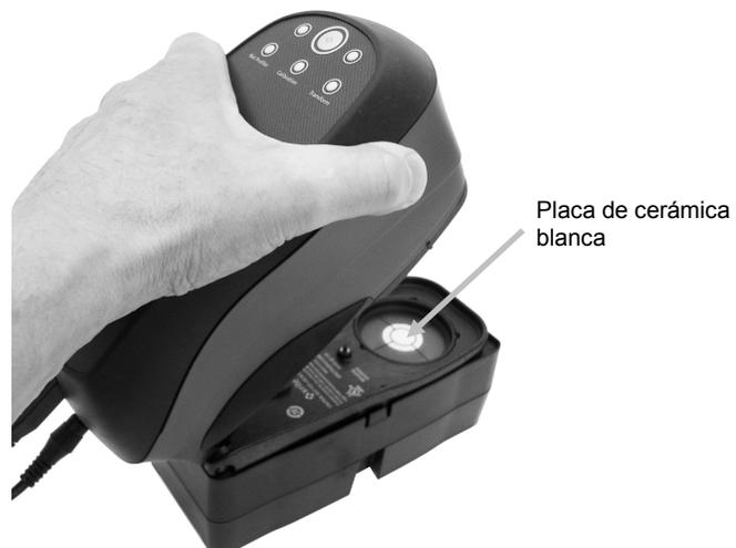
4. Presione firmemente el instrumento en la zapata. Mantenga fijo el instrumento hasta que el indicador del estado de la medición cambie al color ámbar y, a continuación, al color verde. El indicador de calibración debe cambiar al color rojo.
