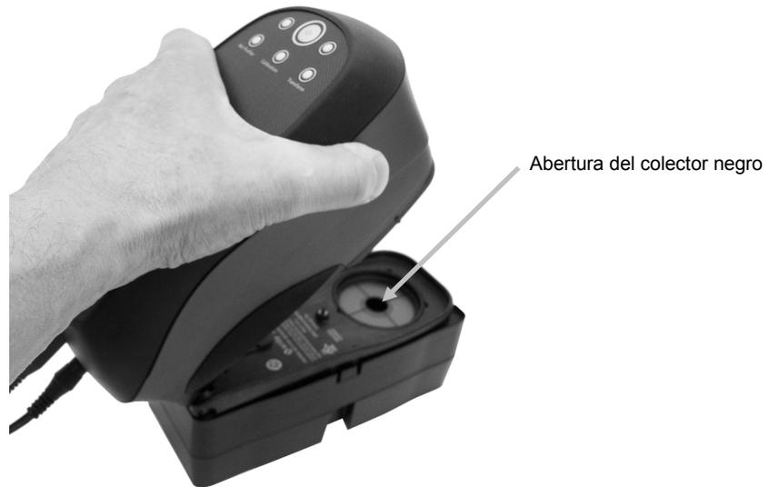
8. Presione firmemente el instrumento en la zapata. Mantenga fijo el instrumento hasta que los indicadores del estado de la medición cambien al color ámbar y, a continuación, al color verde, y el indicador de la calibración cambie al color verde. Esta es una indicación de que el procedimiento de calibración se ha realizado correctamente.
