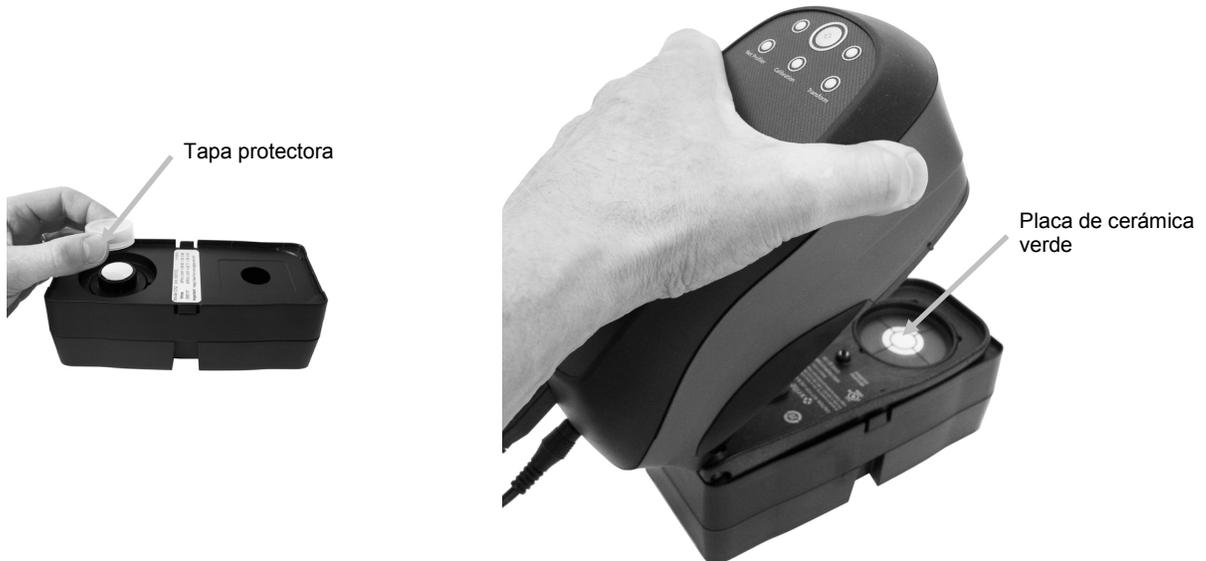
5. Presione firmemente el instrumento en la zapata. Mantenga fijo el instrumento hasta que el indicador del estado de la medición cambie al color ámbar y, a continuación, al color verde. El indicador de calibración debe cambiar al color rojo.
