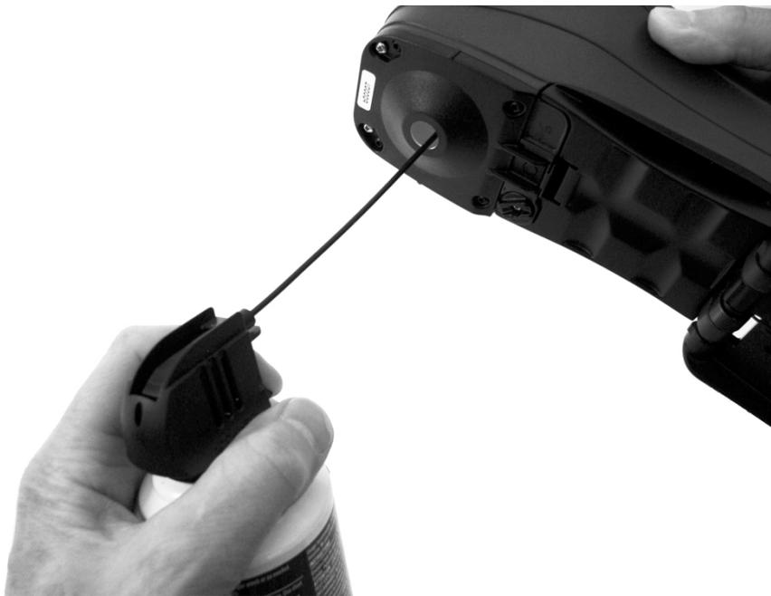
**IMPORTANTE:** Si se utiliza aire para la limpieza, no gire o incline la lata durante el uso. Esto puede causar daños al ensamblaje de la óptica.
