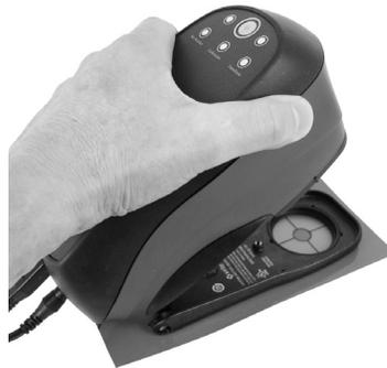
3. Presione firmemente el instrumento contra la zapata. Los indicadores de medición cambian al color ámbar. Mantenga fijo el instrumento hasta que los indicadores del estado de la medición cambien al color verde seguido de un pitido. Esta es una indicación de que la medición se ha realizado correctamente.
