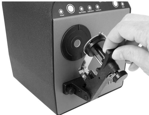
3. Tirez sur le bouton et placez l'échantillon de couleur entre le dispositif de serrage et la bague de retenue. Assurez-vous que la face de l'échantillon à mesurer est bien orientée vers le port de mesure.
