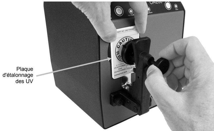
4. Fermez le dispositif de serrage du porte-échantillon contenant la plaque d'étalonnage des UV.
